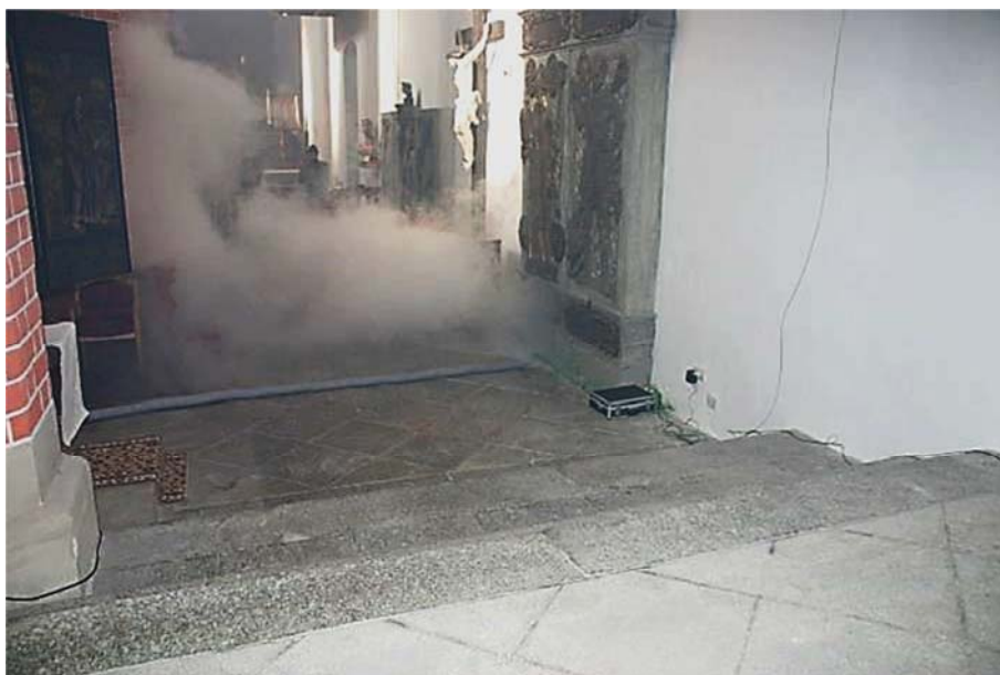
Abb. 15 Nebelversuch zur Visualisierung von Raumluftrömungen in der Klosterkirche Quelle: IDK e.V.
