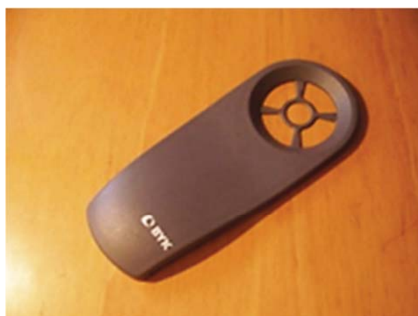
Abb. 91 Farbmessgerät "spectro-guide sphere gloss" (links) / Messschablone (rechts) Quelle: Quelle: N. Lange
