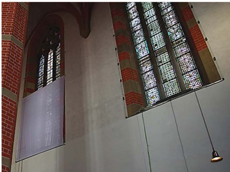
Abb. 26 Installierte Windschottsysteme zur messtechnischen Beprobung links: Stoffvariante, rechts: Plexiglasvariante Quelle: Frei, Stefan (2011)
