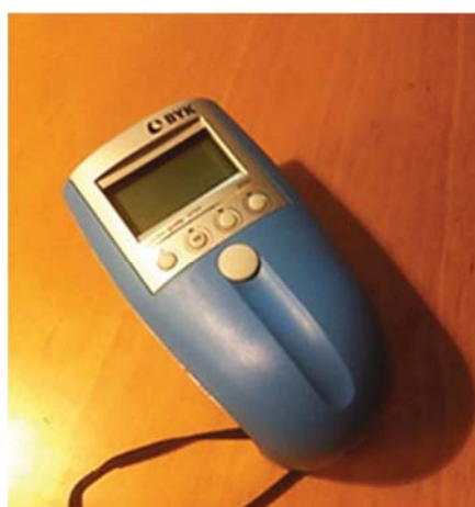
Abb. 91 Farbmessgerät "spectro-guide sphere gloss" (links) / Messschablone (rechts) Quelle: Quelle: N. Lange
