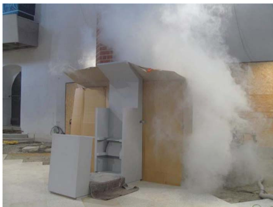
Abb. 80 Musterchorgestühl mit temporären Wänden bei Versuchen zur Luftströmungserfassung bei Rauchversuchen (2008) Quelle: IDK e.V.
