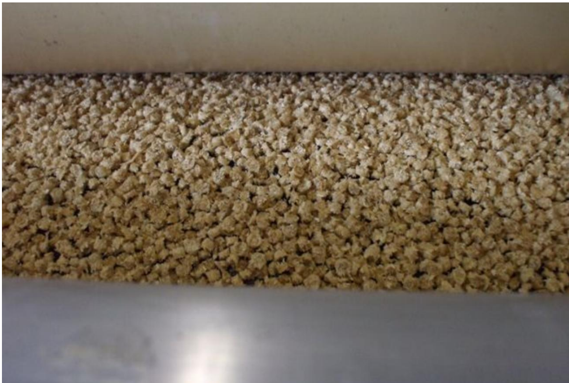
Abb. 18 Angeschmolzenes Agglomerat am Ausgang der Anschmelzvorrichtung (SUV)
