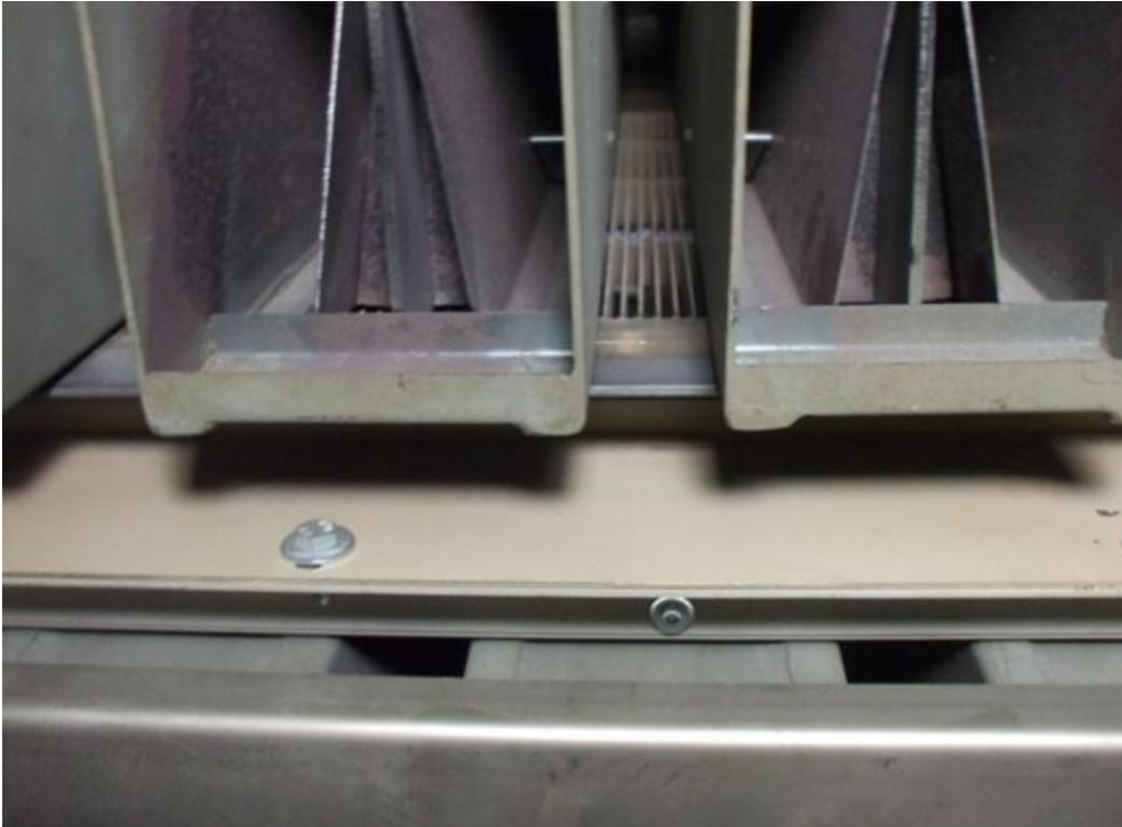
Abb. 17 Düsenrohr mit Venturileiste und vertikal verstellbarem Lamellenband
