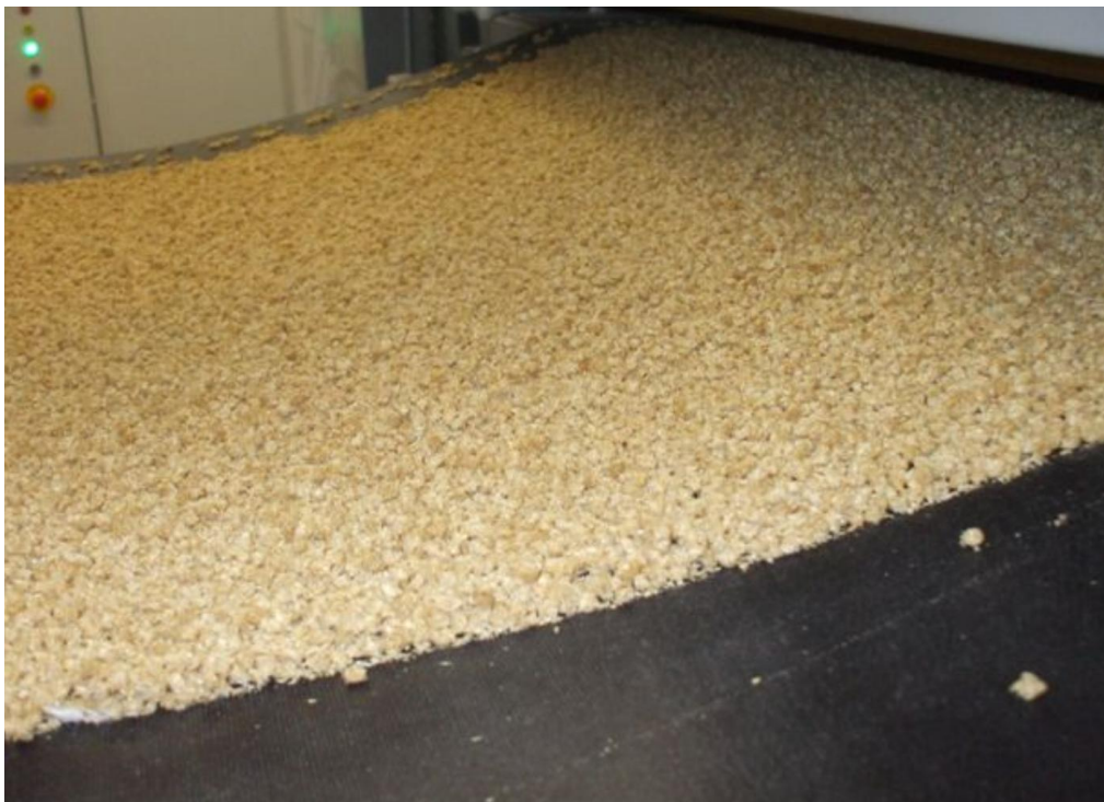
Abb. 16 WPC-Schüttgut auf dem Transportband zwischen Streuer und Anschmelzvorrichtung (SUV)
