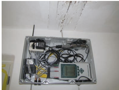
Im Gerätekasten ist ein Datenlogger zur Erfassung und Speicherung der Daten eingebaut, der mit einem Modul zur Datenübertragung per UMTS an das Fraunhofer Institut für Bauphysik versehen ist (Bild 21). Dadurch kann die Funktionsfähigkeit der Datenerfassung sowie die Plausibilität der Ergebnisse von Holzkirchen aus ständig überprüft werden. In Bild 22 ist eine Ansicht der Unterseite des Gerätekastens abgebildet. Deutlich erkennbar ist der Kombisensor, aber auch die Messausgänge für die Holzfeuchtemessungen. Die Holzfeuchte muss diskontinuierlich durch Anschließen des Holzfeuchtemessgerätes vor Ort erfolgen, da eine kontinuierliche Messung derzeit noch mit zu großem finanziellem Aufwand verbunden ist. Der Betreuer vor Ort sowie später die Mieterin haben sich aber bereit erklärt, diese Messungen in regelmäßigen Abständen durchzuführen und zu protokollieren und die Ergebnisse den Mitarbeitern am IBP mitzuteilen.
