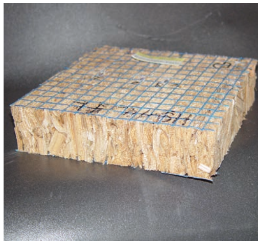
Bild 4: Chip-Board mit überwiegend senkrecht zur Plattenebene orientierten, größeren Partikel, zusammen mit den Materialkennwerten, Foto IBP
