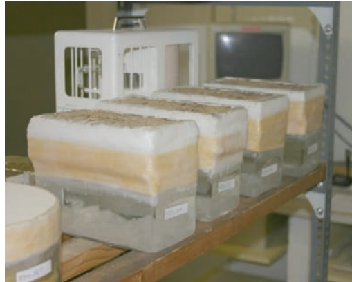
Bild 2: Auf die Prüfgefäße dicht aufgebrachte Typha-Platten während der Diffusionswiderstandsmessung, Foto IBP
