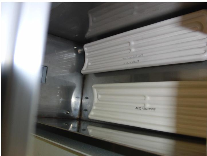
**Abbildung 4: Blick von unten in die zwischen Sprühprimerung und Bebilderungsteil untergebrachte Heizbrücke - man erkennt die Keramikheizelemente**
