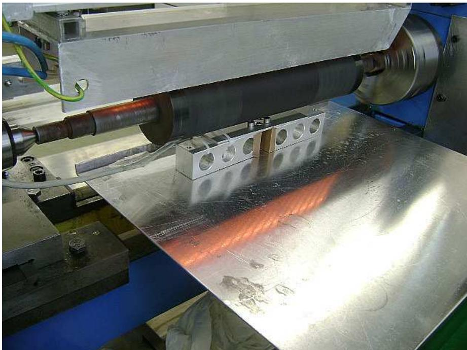
**Abbildung 21: Ansicht von der Rückseite auf die Walze beim Heizen - unter der Walze ist die Halterung für den IR-Sensor zu sehen. Der Sensor befindet sich zwischen den beiden gelochten Klötzen in dem Verbindungsblech**
