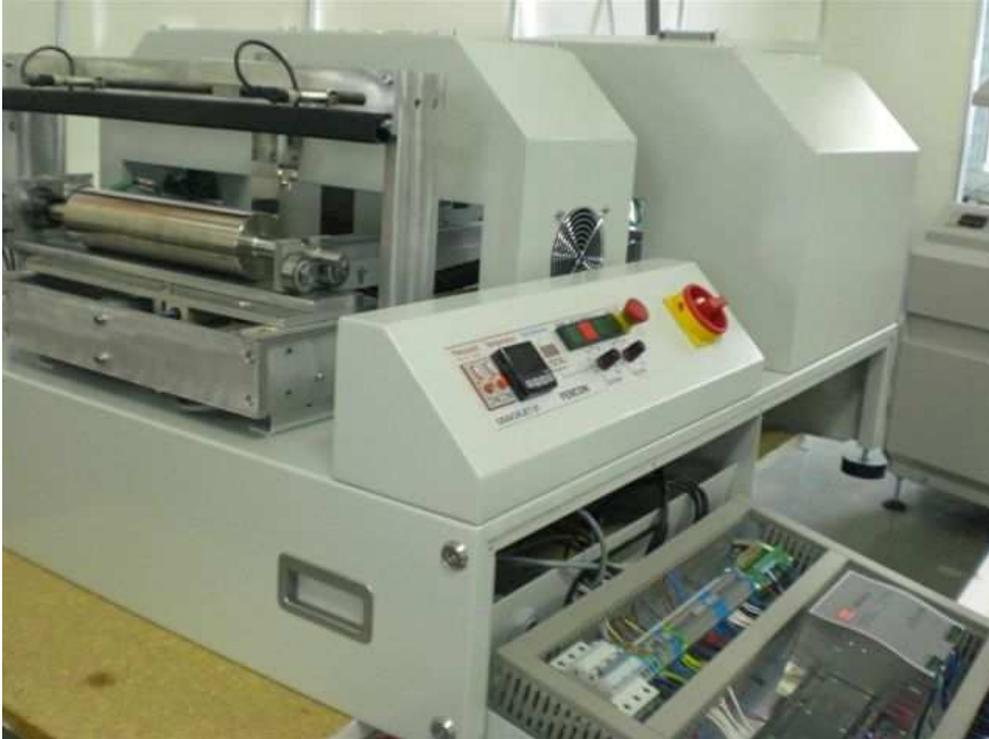
**Abbildung 5: Leistungsversorgung und Steuerung im mittleren Teil des Gravurejet 01**
