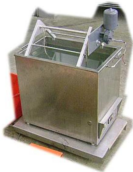
**Abbildung 27: Ultraschallreiniger mit aufgesetzter Walzendrehvorrichtung**
