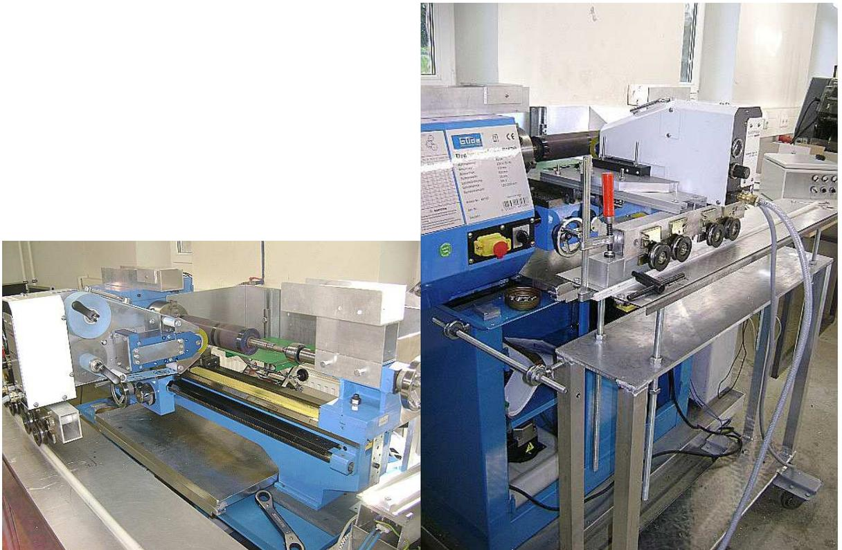
**Abbildung 9: Adaption des Bandpoliergerätes von Thielenhaus an die Drehbank**
