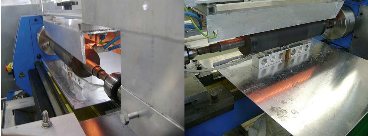
**Abbildung 8: Seitlicher Einblick (links) in die Heizvorrichtung im Betrieb (IR-Strahler mit Abschirmung oben, Walze unten) und rechts der Blick von der Rückseite im Betrieb mit unter der Walze befindlicher Halterung für den IR-Temperatursensor zur Heizungsregelung**
