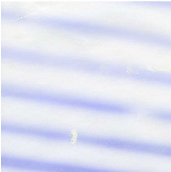
**Abbildung 16: Auftrag von eingefärbtem Primer auf eine mit Papier umwickelte Walze – das Papier ist hier abgewickelt**
