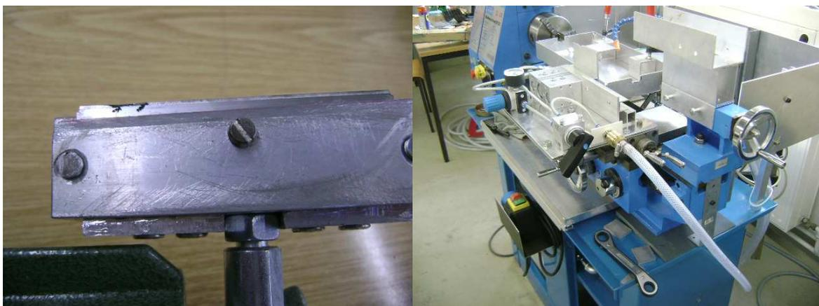
**Abbildung 7: Hobelklinge und Halter (links, mit einer kleinen Portion abgehobelten Bebilderungsmaterials auf der Klinge) und Drehbank mit vorgebauter pneumatischer Halteranstellung**
