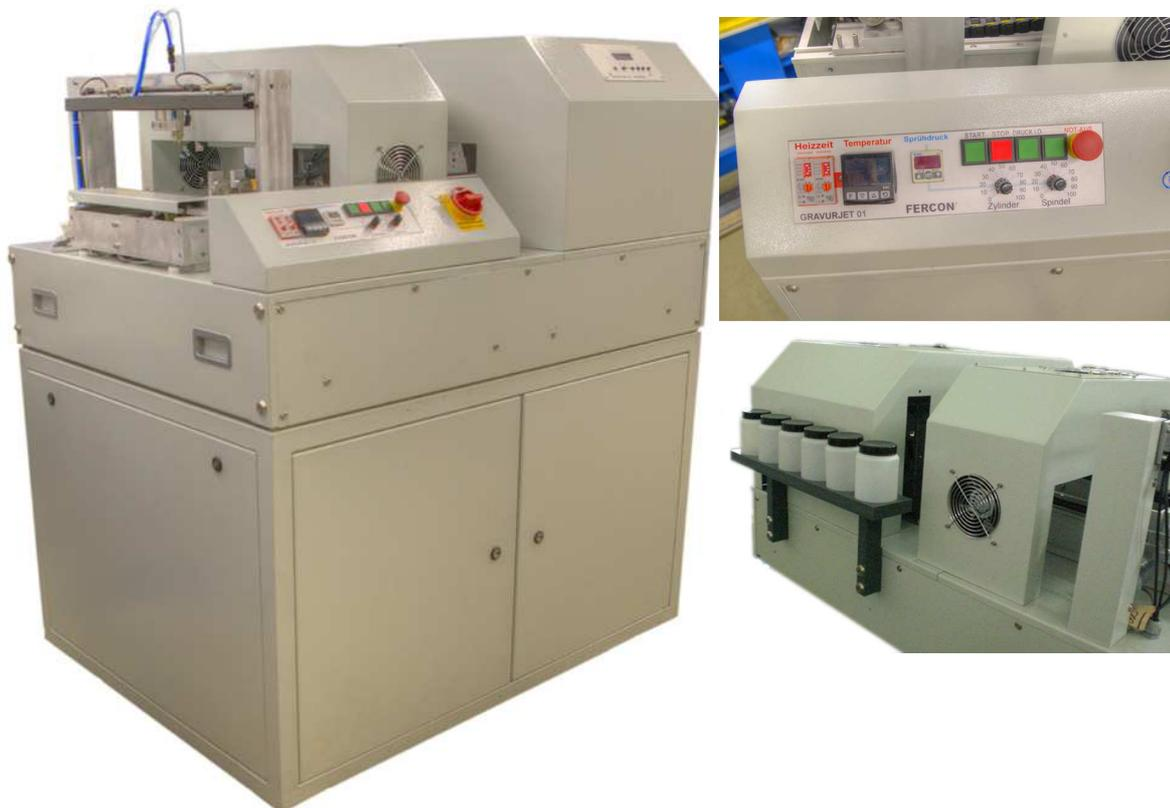
**Abbildung 2: Bebilderungseinrichtung Gravurejet 01 (links) der Firma FERCON mit Detailansichten des (rechts) Bedienpanel Sprühprimerung und Trocknung und der Versorgung mit Bebilderungsmaterial**
