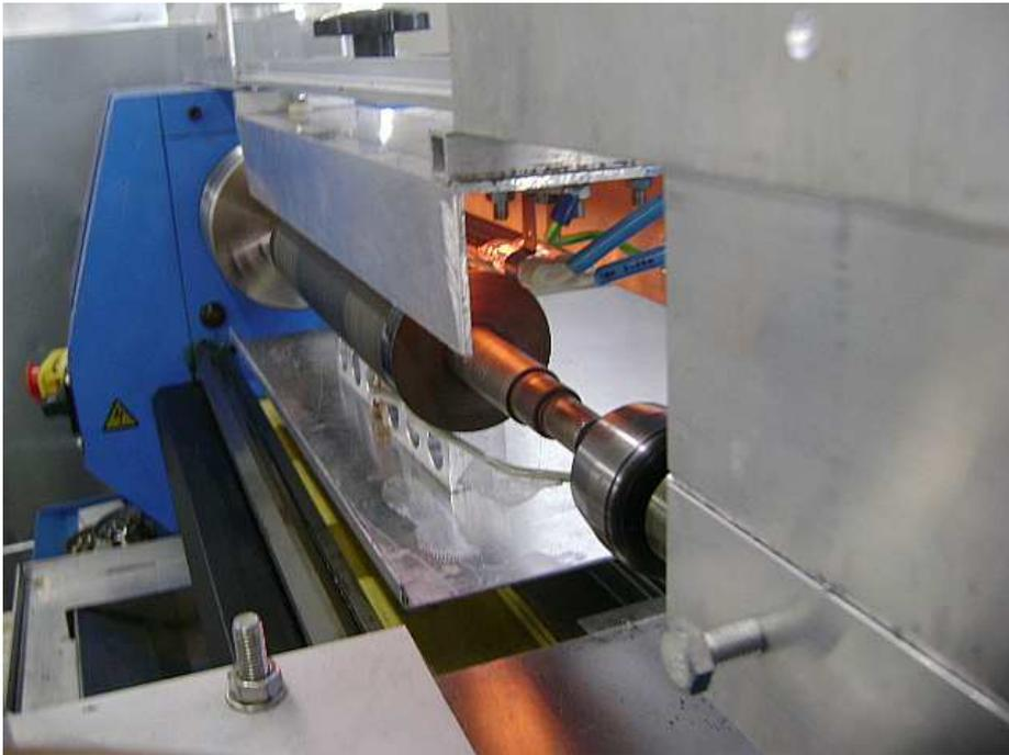
**Abbildung 22: Blick in Achsenrichtung in die U-förmige Strahlerhalterung - man erkennt den Beginn des Strahlers, der über den Walzenballen hinausragt**
