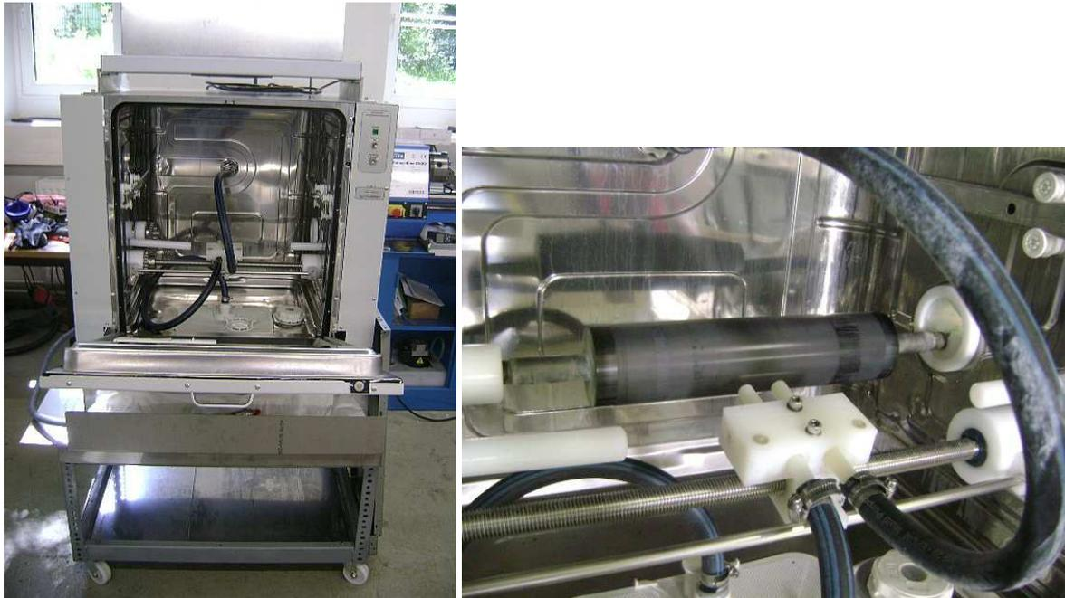
**Abbildung 6: Walzenwaschmaschine (links, geöffnet) und Innenansicht (rechts) bei eingebauter Walze mit traversierender Düse**
