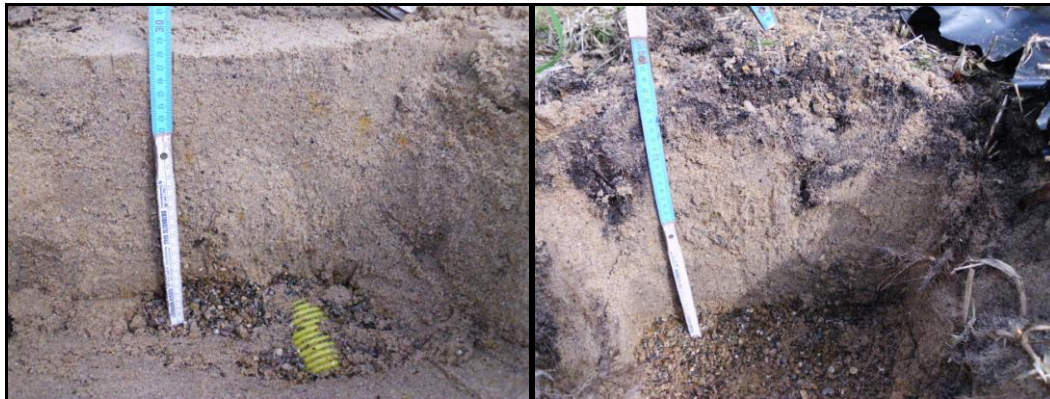
Abbildung 20: Entwicklung der Filtersubstrate nach etwa 1½ Jahren Versuchsbetrieb: links Filter „S“ ohne Bodenentwicklung, rechts „2F“ mit intensiver Durchwurzelung und erkennbarer Humusanreicherung.
