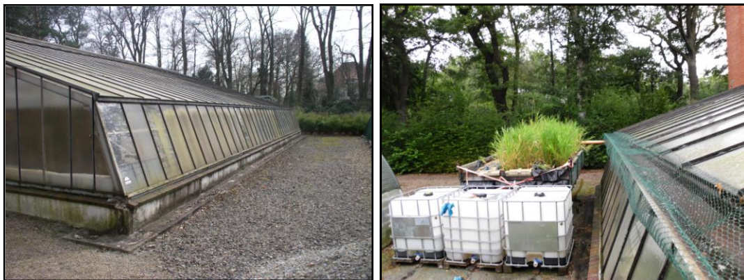
Abbildung 4: Versuchsgewächshaus „Azaleenhaus“ (li.), längsseitige Dachrinne und VersuchsfILTERanlage im Betrieb (re.).
