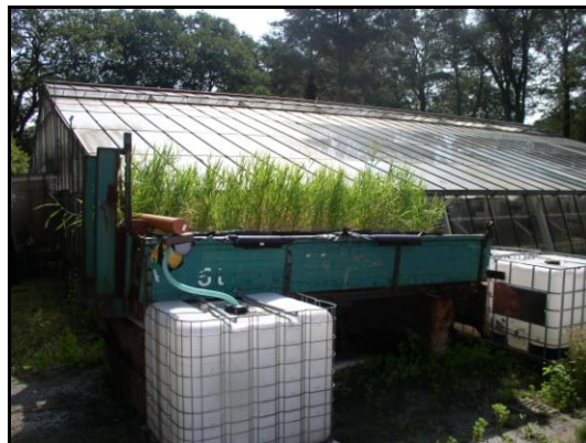
Abbildung 10: Versuchsfilteranlage mit etablierter Bepflanzung nach einem halben Betriebsjahr (28.07.2011); erkennbar ist das Gefälle der Filteranlage und im Vordergrund die Bewässerungskulisse mit LBC-Container für ungefilterten Dachablauf (Var. „D“), im Hintergrund LBC-Behälter für Filtervarianten „S“, „1F“, „2F“.
