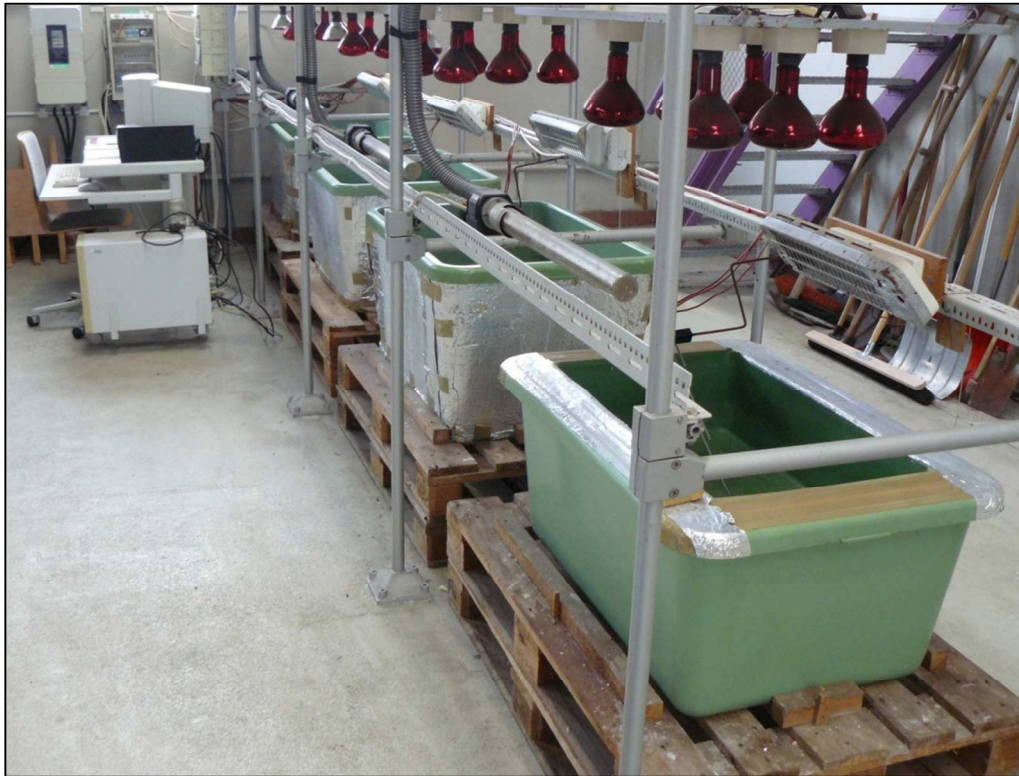
Abbildung 11: Modellanlage zur Nachbildung von Evaporationsprozessen; Technikum K-UTEC
