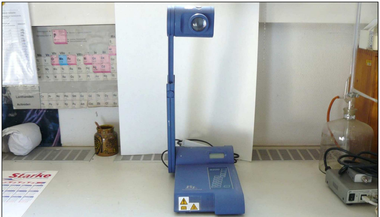
Abbildung 38: Apparatur zur Schmelzpunktbestimmung; Technikum K-UTEC
