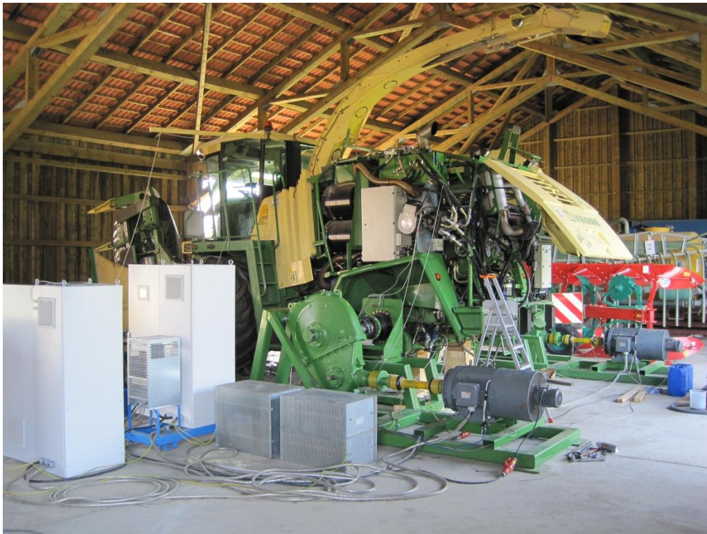
Anhang 5: Prüfstand Hinterachsantrieb in der Halle des Staatsgutes Dürnast (Foto: M. Heckmann)
