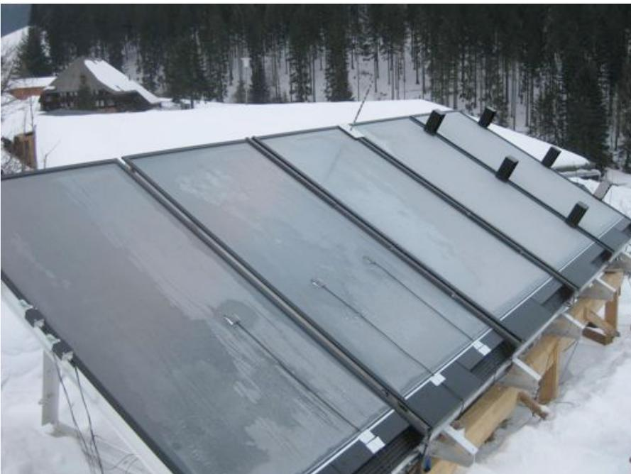
Abbildung 2: Kollektorfeld der Schneetestanlage: hinten mit passiven Schneeblechen, die über den Schnee ragen, zum Anschmelzen, überall mit Schneeschutz über dem Luftauslass
