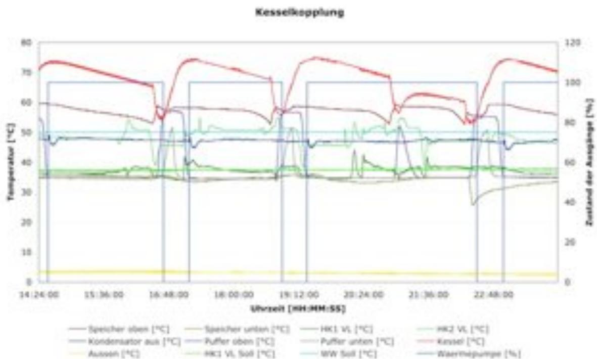
Abbildung 4: Temperaturverläufe bei Kesselkopplung mit 2 Heizkreisen: Heizkreis 2 mit ca. 60 °C, Heizkreis 1 ca. 40 °C
