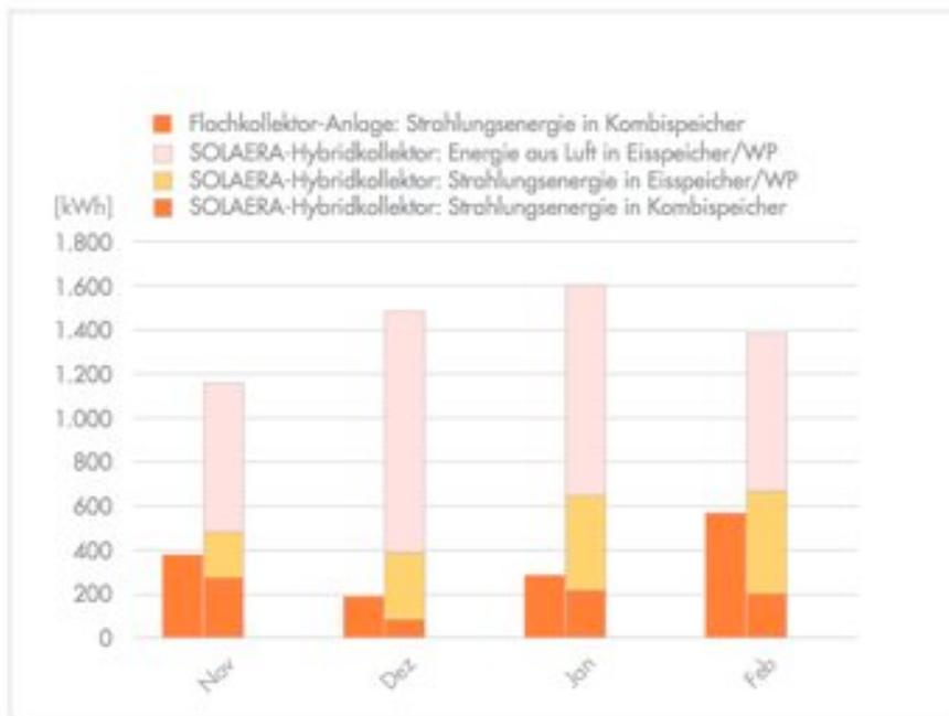
Abbildung 9: Vergleich der Kollektorerträge einer großen Anlage zur solaren Heizungsunterstützung (links) und SOLAERA (rechts) während der vier Wintermonate (Würzburg)
