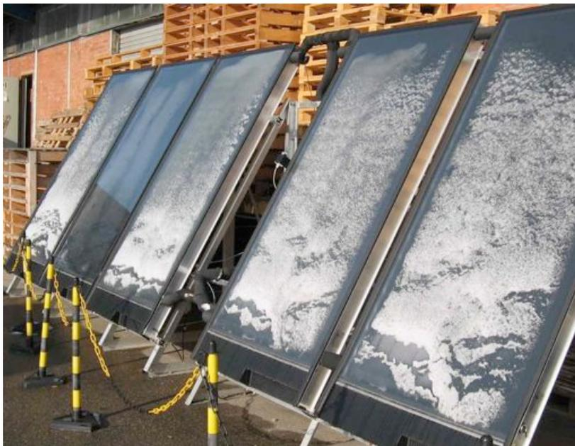
**Abbildung 14: Der zweite Kollektor von hinten hat eine perfekt glatte Oberfläche, der Schnee rutscht dort schneller ab**
