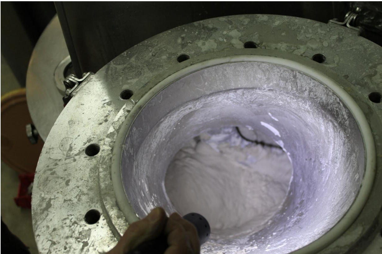
Foto 3-3: Schleifstaubsuspension nach Homogenisierung
