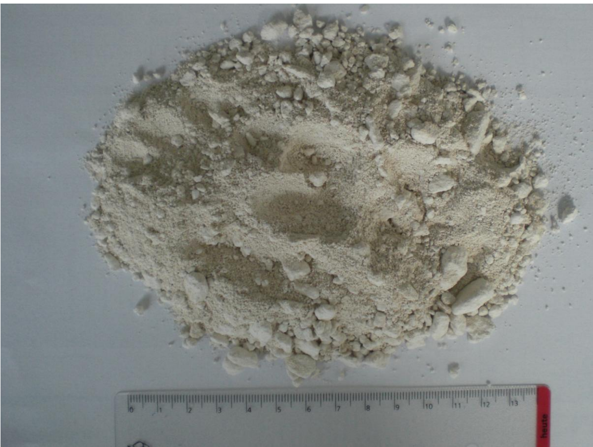
Foto 5-3: Gipsfraktion mit optimaler Retention, kaum Fasern sichtbar
