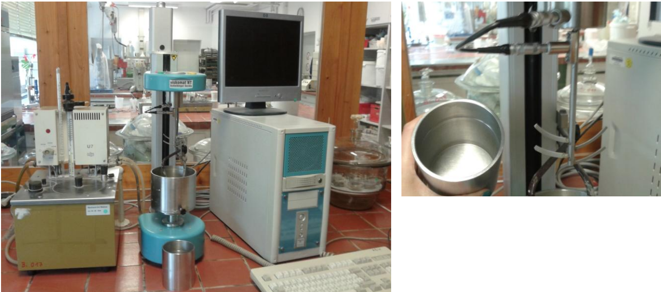
Foto 0-1: Versuchsaufbau zur Viskositätsbestimmung mit dem Viskomat NT
