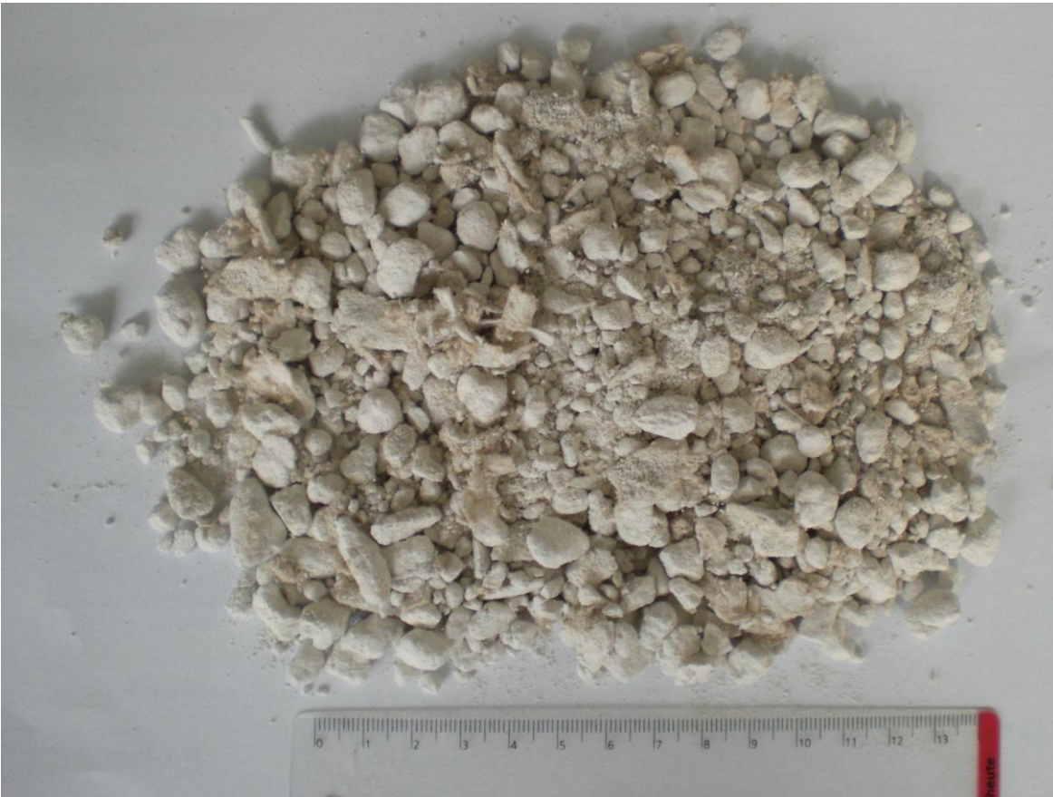
Foto 5-3: Gipsfraktion mit optimaler Retention, kaum Fasern sichtbar
