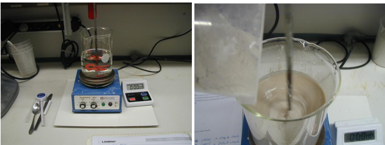
Foto 0-2: Versuchsaufbau zur Herstellung der Suspensionen für die Bestimmung des FM bei Lindner
