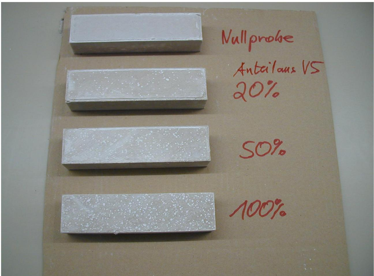
An den Ergebnissen zeigt sich, dass die Umkristallisation wichtig für die Einsetzbarkeit in den GFP Herstellprozess ist. Mit dem Staub ist dies nur möglich, wenn bei Schüttungen oder Presslingen ausreichend Feuchte im Produkt vorhanden ist. Die losen Schüttungen sind unter den in diesem AP gewählten Bedingungen dafür nicht geeignet.
