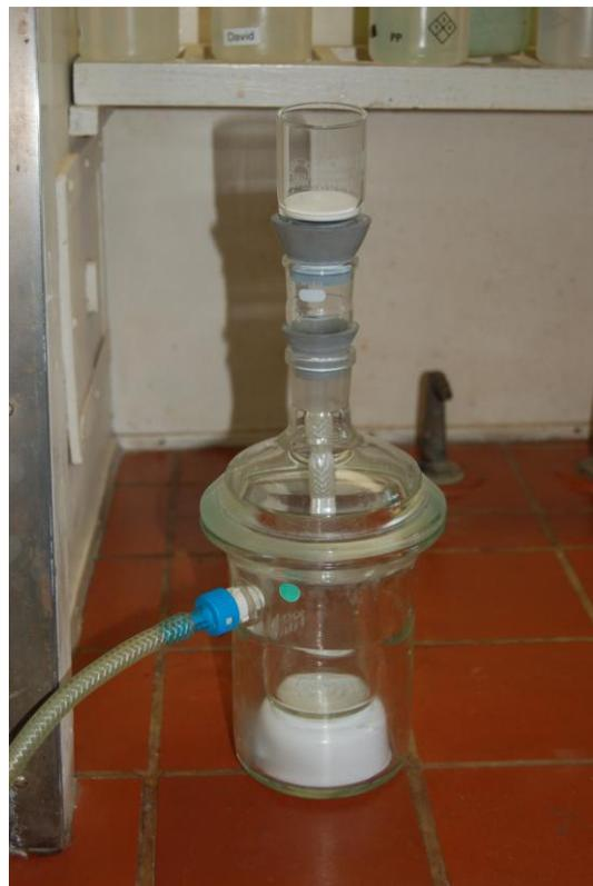
Das Vorgehen zur Abstopfung der Reaktion entspricht im Wesentlichen dem vorher beschriebenen Verfahren zur Abstopfung und Filtrierung des  $\alpha$ -HH aus der im Reaktor erzeugten heißen Suspension.
