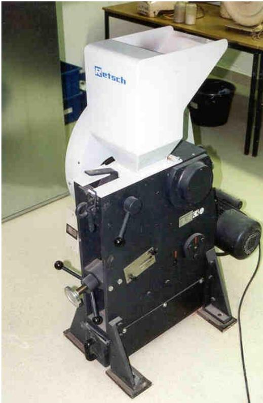
Im nächsten Schritt wurden die Presslinge unter Verwendung der Feinprallmühle NOSSEN (Schlagscheibendurchmesser: 240 mm) gemahlen. Hierfür mussten die Presslinge zunächst im Laborbackenbrecher RETSCH BB 200 vorzerkleinert werden.
