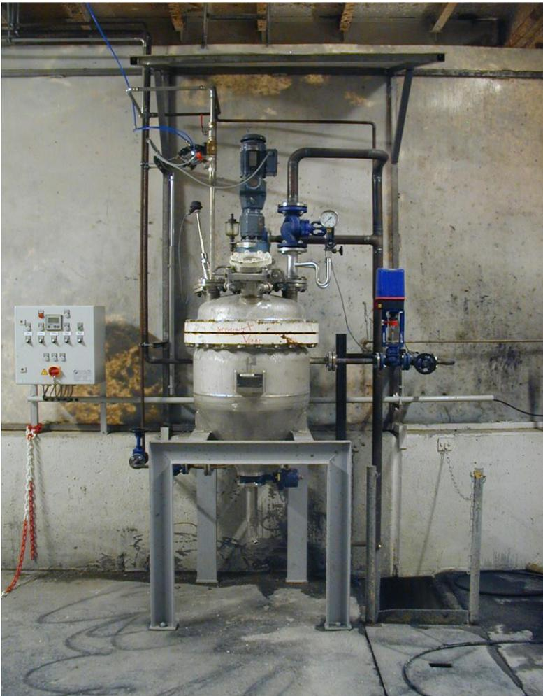
Der Reaktor wurde vor Start des Projektes isoliert, um möglichst praxisnahe wärmetechnische Bedingungen vorliegen zu haben, Foto 0-1 zeigt den nicht isolierten Behälter mit Installationen.
