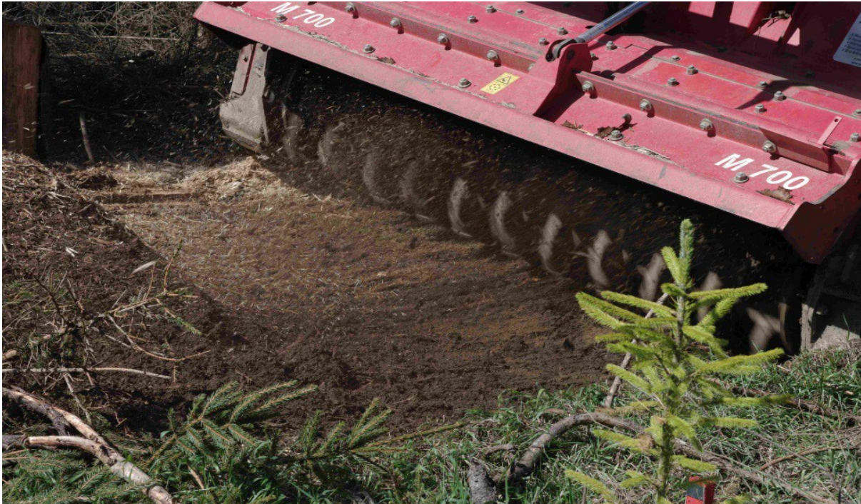
Abbildung 80: Entstehung einer Frässohle beim Mulchen
