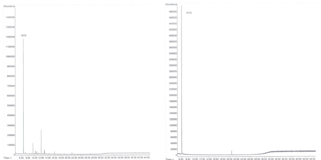
Abb. 4-11: GC-MS Chromatogramme für anaerob (links) und anaerob+aerob (rechts) behandeltes HTC-Prozesswasser, Einsatzmaterial: Speisereste
