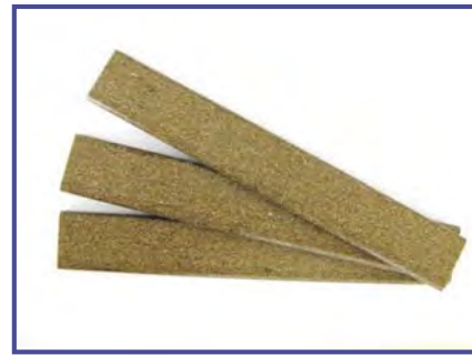
10% Hanf, Pellets 02/2012 mit 20% Copolymer
