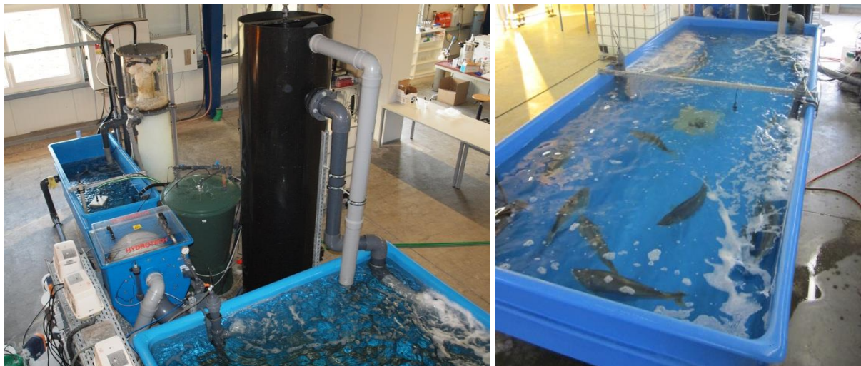
Abbildung 2 – Blick auf den Fluid-Kreislauf mit seiner Wasseraufbereitung in der Forschungshalle Völklingen (HTW). Links: Komponenten der Wasseraufbereitung. Rechts: Haltungstank mit Fischbesatz ( Seriola lalandi )
