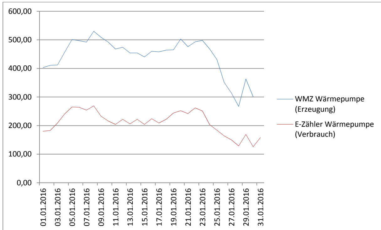
Abb.119 Gemessene Werte; WMZ Wärmepumpe (Erzeugung) E-Zähler Wärmepumpe (Verbrauch) in kWh, Januar 2016
