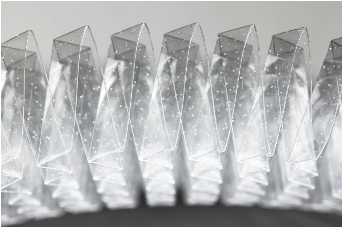
Abb. 46: Demonstrator: Faltern aus einer mikroperforierten PLA-Folie; Herstellung: Foldcore GmbH; Bild: ITKE Fotograf: Michael Damböck
