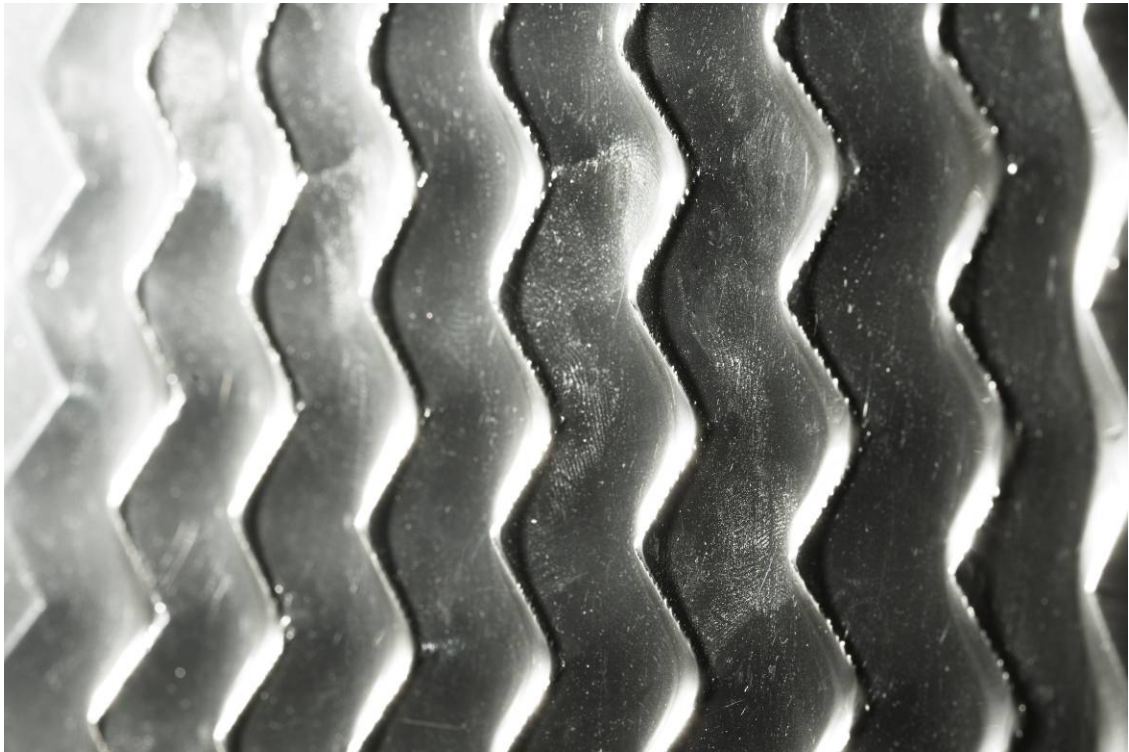
Abb. 89: Unterseite des Formkörpers aus Cellulosediacetat: keine exakte Abformung
