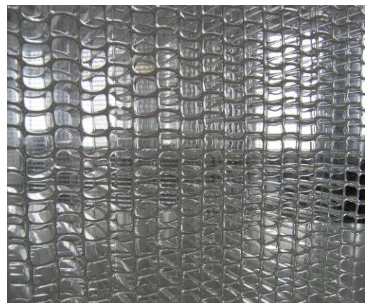
Abb. 26: Wabenstruktur und mikroperforierte Deckschichten aus Cellulosetriacetat Folien
