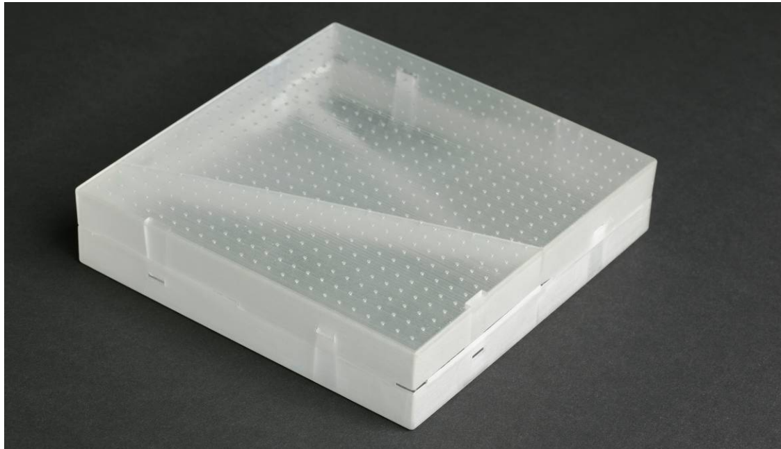
Abb. 138: Modellstudie (im 3D Sinterverfahren hergestellt) Bild: ITKE © M. Damböck
