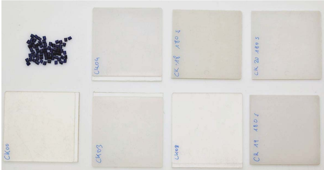
Abb. 153: Ergebnisse nach Zugabe unterschiedlicher Mengen eines optischen Aufhellers (blaues Granulat)
