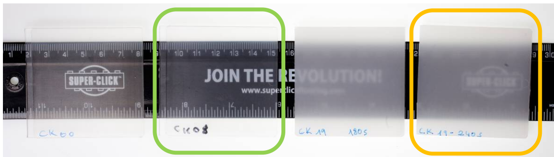
Abb. 158: Durchschnittliche Wärmeformbeständigkeit (HDT-B) der markierten Platten (Stärke 2 mm): 45,6°C (grün) und 79,9°C (orange)
