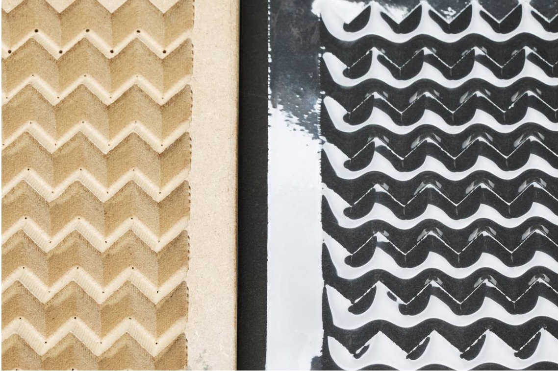
Abb. 87: Tiefziehwerkzeug (links) und Formkörper aus Cellulosediacetat (rechts)
