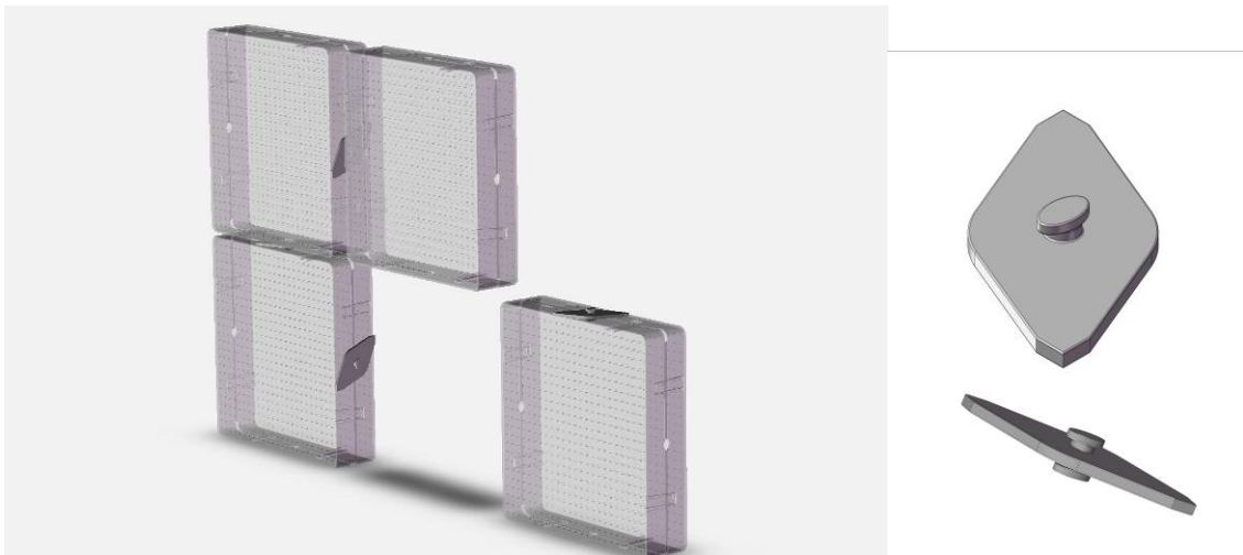
Abb. 128: CAD Studie Excenter-Verriegelung
