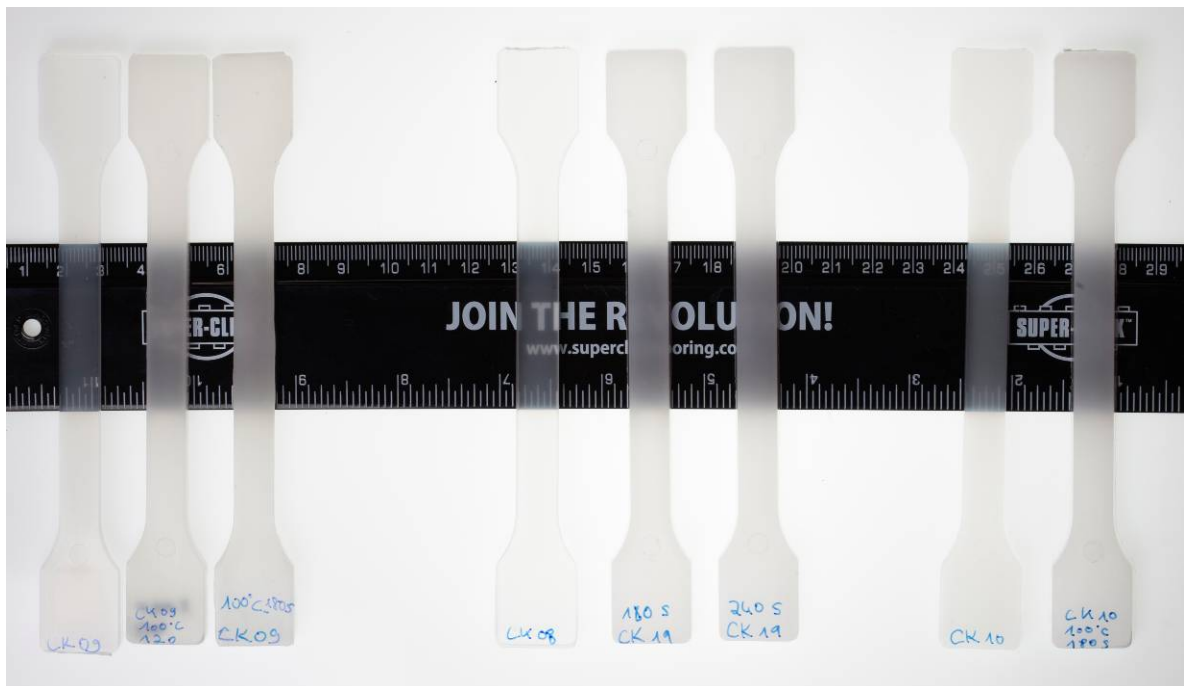
Abb. 151: Modifiziertes Polylactid: Darstellung unterschiedlicher Transparenzgrade
