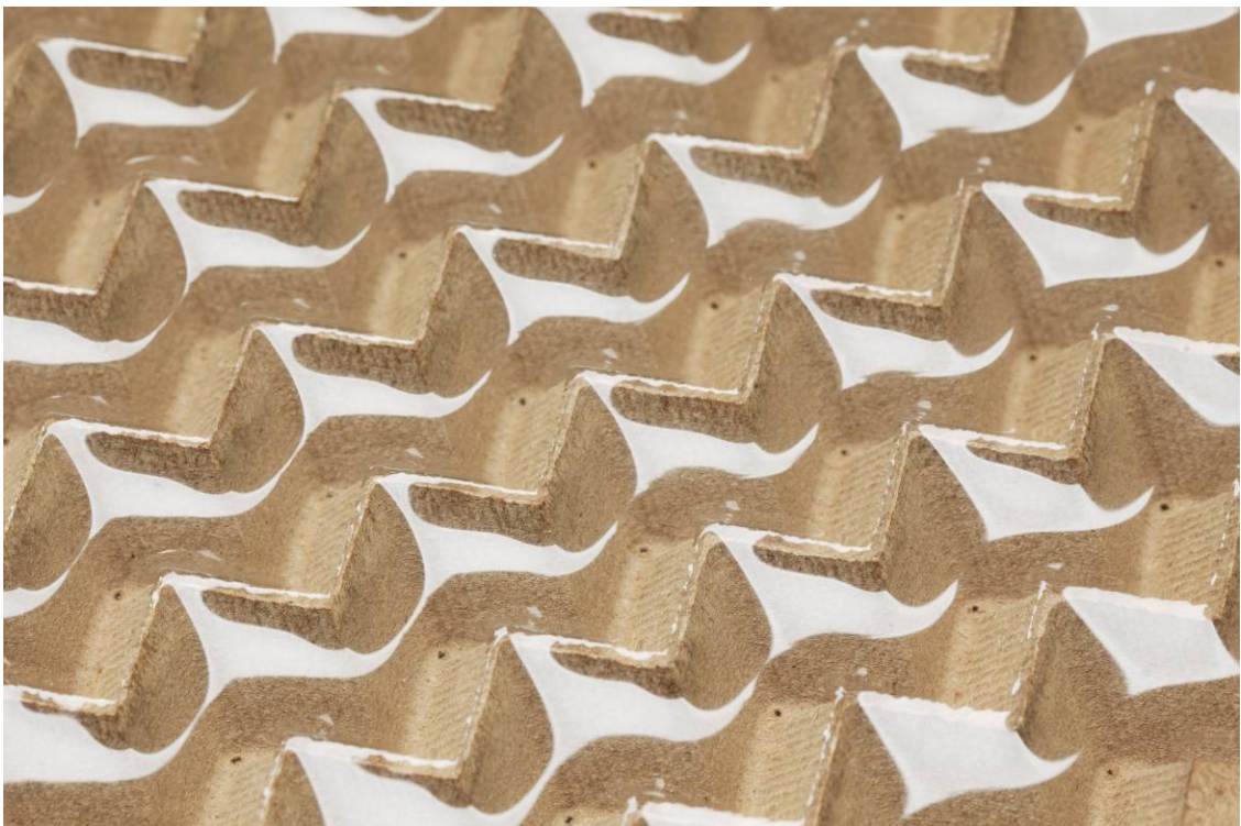
Abbildung 88: Tiefziehen einer flammgeschutztausrüsteten Cellulosediacetatfolie
