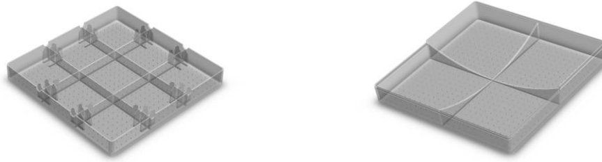
Abb. 110: Konzeptstudien: Halbschalenmodule mit Verstärkungsstegen
