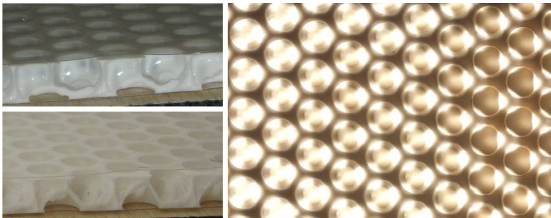
Abb. 42: Demonstrator – TRlcore-Kern aus einen PLA-PHB-Blend, Bild2: hinterleuchtet
