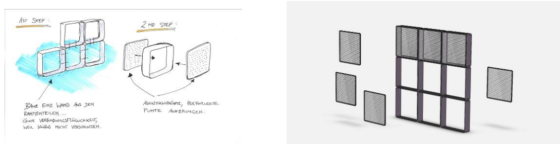
Abb. 119: Konzeptstudie: zweiteiliger Modulaufbau
