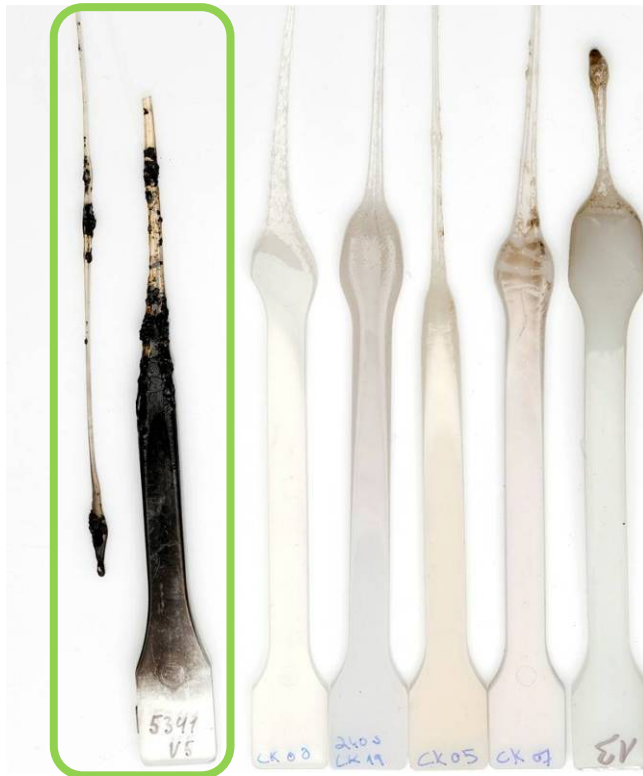
Abb. 149: Prüfstäbe nach dem Brandtest, mark. Stab: Cellulosediacetat + 10wt% TPP
