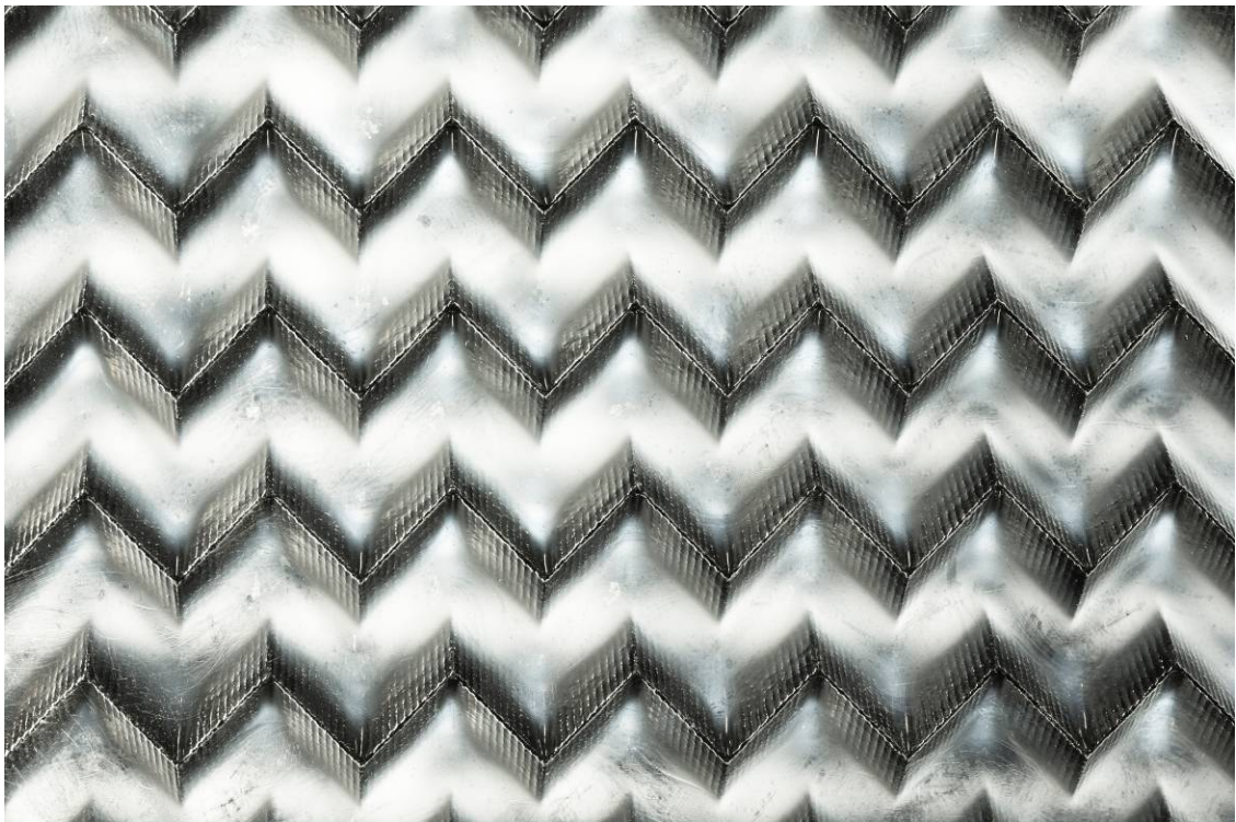
Abb. 90: Probleme beim Tiefziehen einer Biokunststoffolie: milchige Stellen
