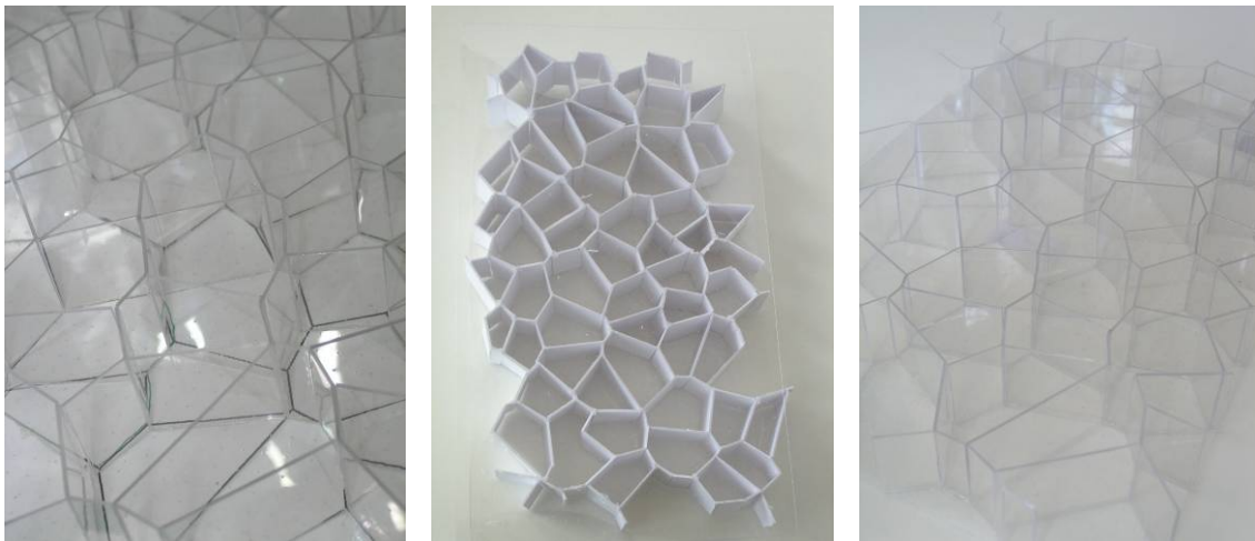
Abb. 48: Demonstratoren mit stehender Wabe in Voronoi Mustern
