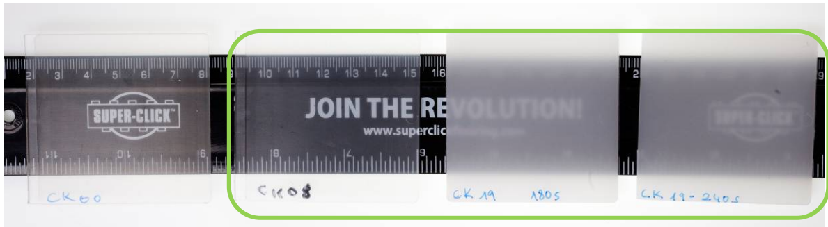
Abb. 150: (Modifiziertes) Polylactid: Darstellung unterschiedlicher Transparenzgrade
