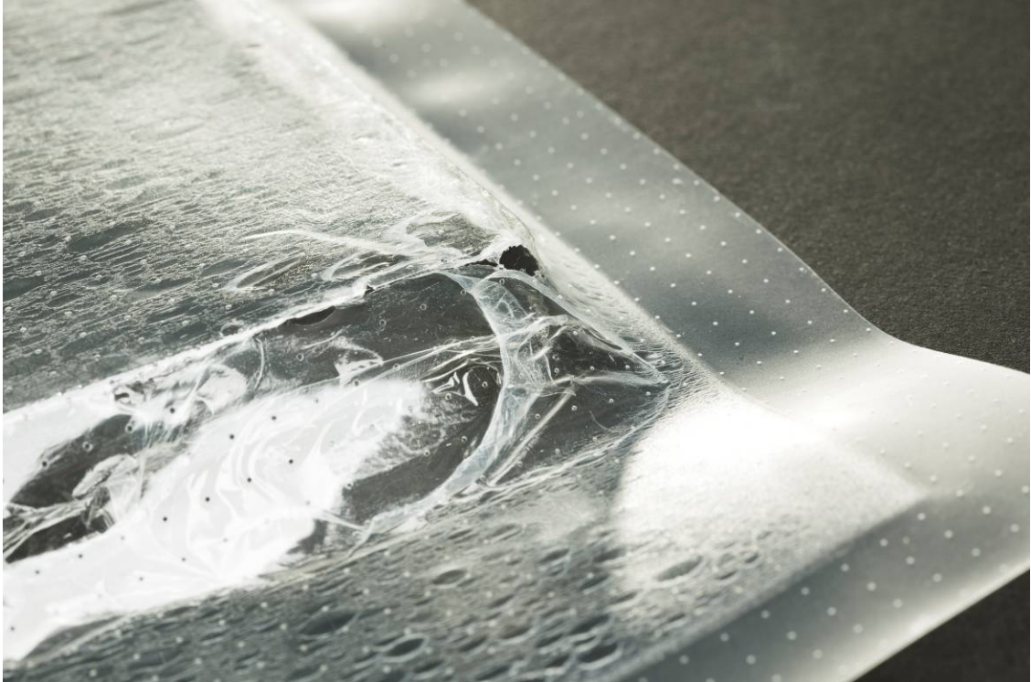
Abb. 92: Ergebnis des Tiefziehversuches einer mikroperforierten und kaschierten Bio-kunststoffolie
