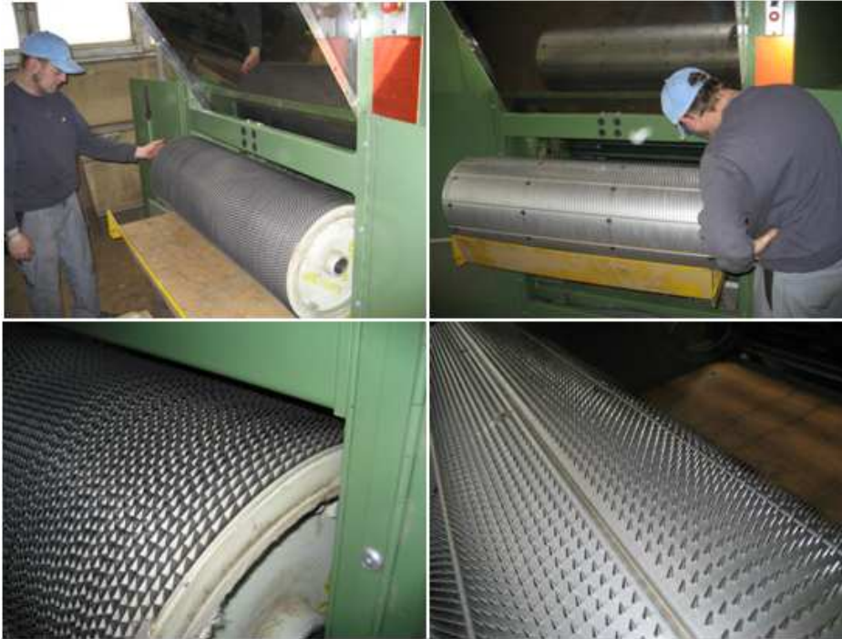
Abbildung 2 Links Sägezahnwalze, rechts Nadelwalze
