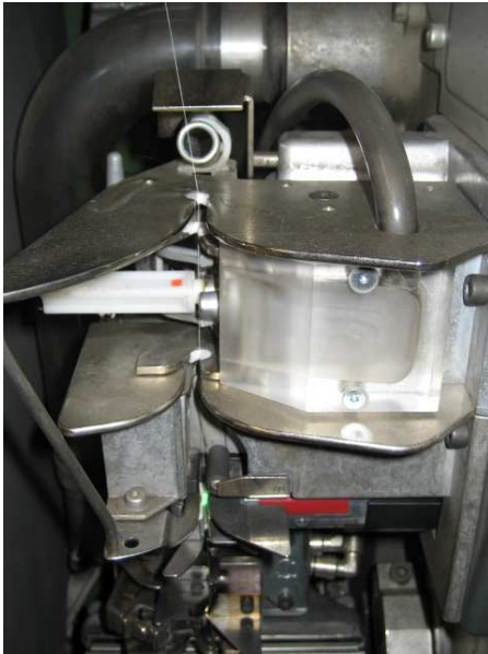
Abbildung 10 Detailaufnahme Autoconer mit eingebauter Absaugereinheit
