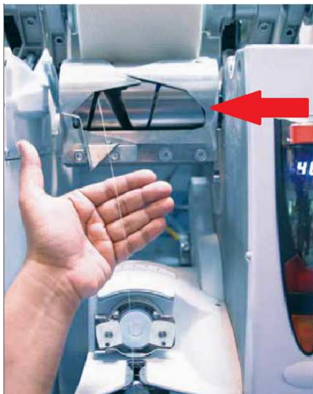
Abbildung 11 Beispiel für eine Fadenführungstrommel in einem Autoconer (siehe roter Pfeil)
