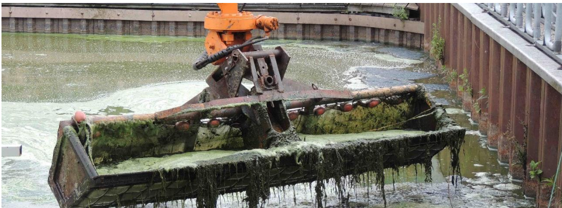
Abb. 83: Vor der Lohne und der Grawiede wurden Blaualgen mithilfe einer Tauchwand abgefangen und mit diesem Räumkorb, der mit einem Vlies ausgekleidet ist, regelmäßig entnommen, abgefahren und auf einer Fläche der Samtgemeinde Lemförde entsorgt. Foto vom 12. August 2013 am SCD.
