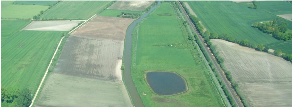
Abb. 354: Kompensationsfläche an der Eisenbahnstrecke Osnabrück-Bremen. Stadt Diepholz und Flächenagentur im Jahr 2000: Größe: ca. 15,4 ha mit einer Flachwassersenke von 5.000 qm und einer temporär gefüllten Senke von ca. 300 qm. Foto vom 16. Mai 2004.
