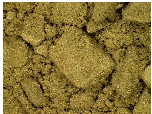
Bilder 3-6: Eisenphosphate mit unterschiedlichen \text{Fe}(\text{OH})_3 - Gehalten gemäß Gesetzmäßigkeit aus Bild 2
