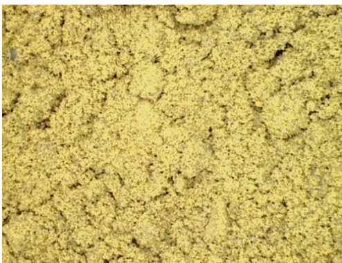
Bilder 3-6: Eisenphosphate mit unterschiedlichen \text{Fe}(\text{OH})_3 - Gehalten gemäß Gesetzmäßigkeit aus Bild 2
