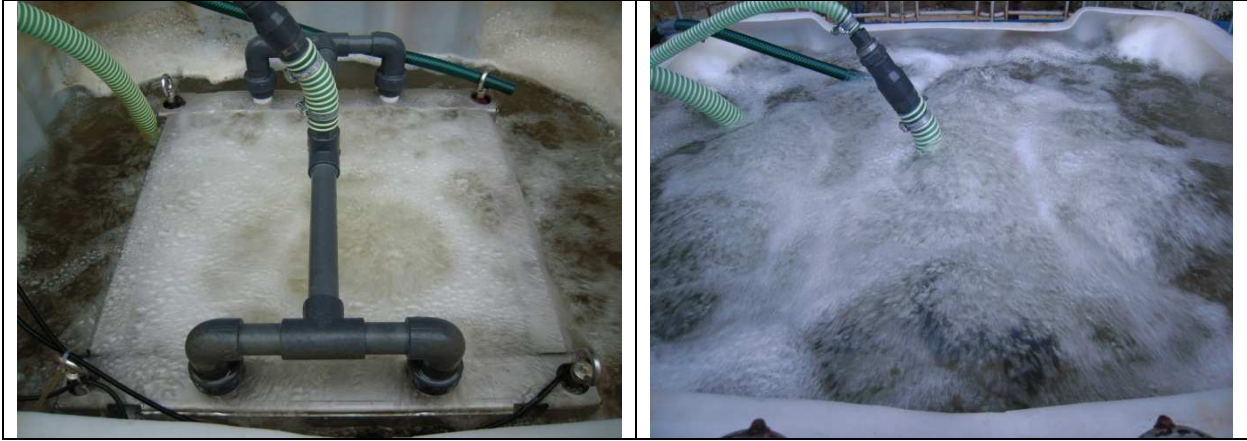
Abb. 1.6 mit Belüftung und geringer Ionisation des Gesamtvolumens
