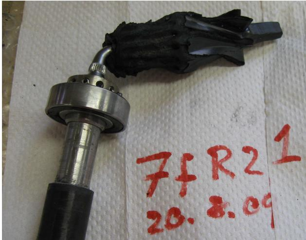
Abbildung 23: Rotor 7fR21 vom 11.08.2009 nach Berstversuch, geborsten bei  $n = 62'100$  1/min. Zu erkennen ist der sehr große und kompakte Kern und die glänzende Oberfläche jenseits der Bruchstellen. Beides spricht für die erreichte Qualität des Spritzgussprozesses.
