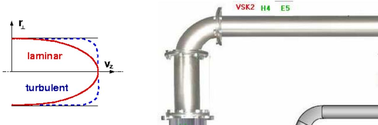
Abbildung 35: Messgrößen und Strömungsprofile für die Berechnung des Dampfmassestromes in der Druckrohrleitung
