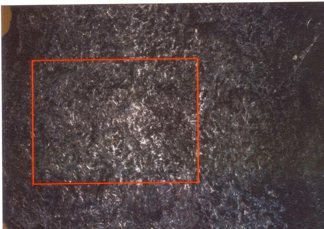
Abbildung 18: Vergrößerte Aufnahme der angussnahen Bruchfläche des Bruchstückes 2. Weiße Bereiche sind Bereiche, aus denen die Fasern heraus gebrochen sind.
