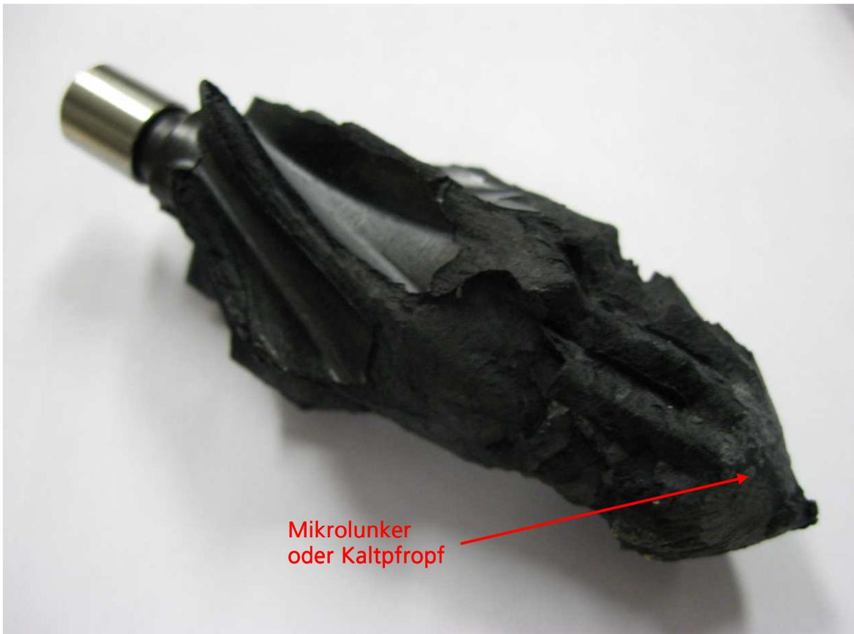
**Abbildung 21: Kern Rotor Welle 6 nach dem Bersten. Ursache für Versagen ist Sollbruchstelle durch Mikrolunker oder Kaltpfropf im Kern des Rotors.**
