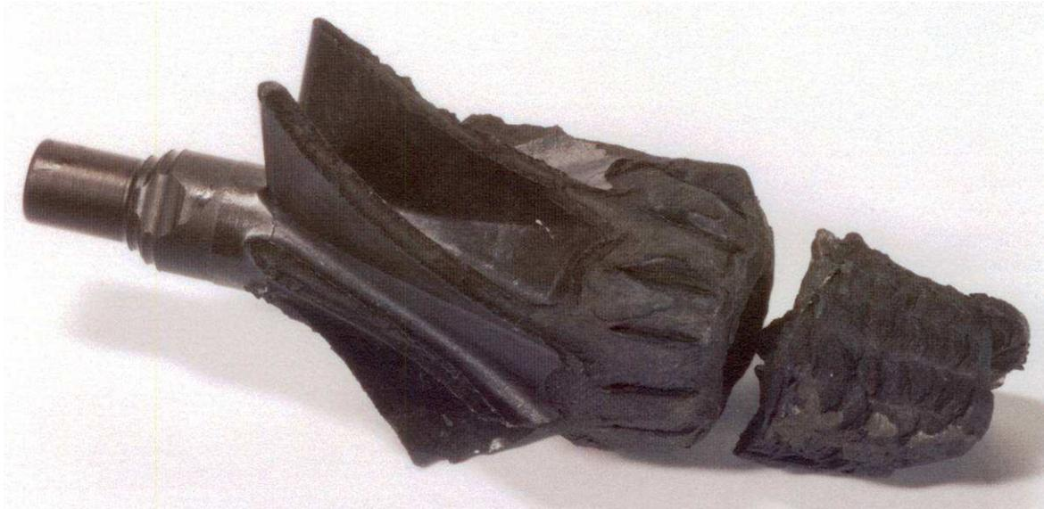
Abbildung 16: Kernbruchstücke einer Rotors, der am LKT der Friedrich-Alexander-Universität Erlangen-Nürnberg lichtmikroskopisch untersucht wurde.
