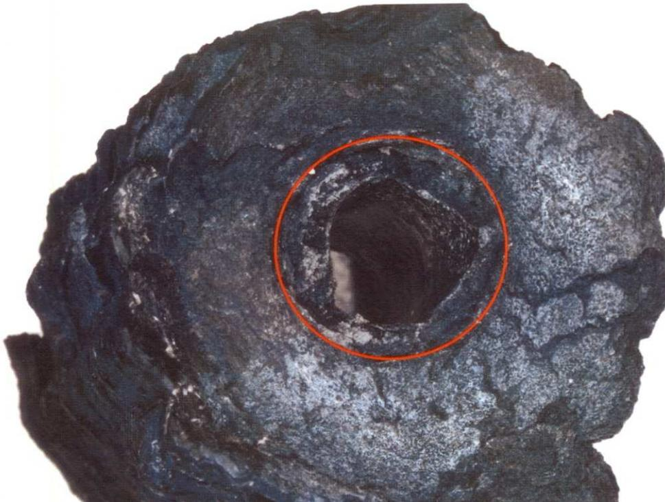
Abbildung 17: Vergrößerte Aufnahme der angussnahen Bruchfläche des Bruchstückes 2. Weiße Bereiche sind Bereiche, aus denen die Fasern heraus gebrochen sind (siehe nächste Abbildung). Die Brüche sind wahrscheinlich nicht während des Bauteilversagens, sondern schon früher aufgrund von eingefrorenen Eigenspannungen aufgetreten.
