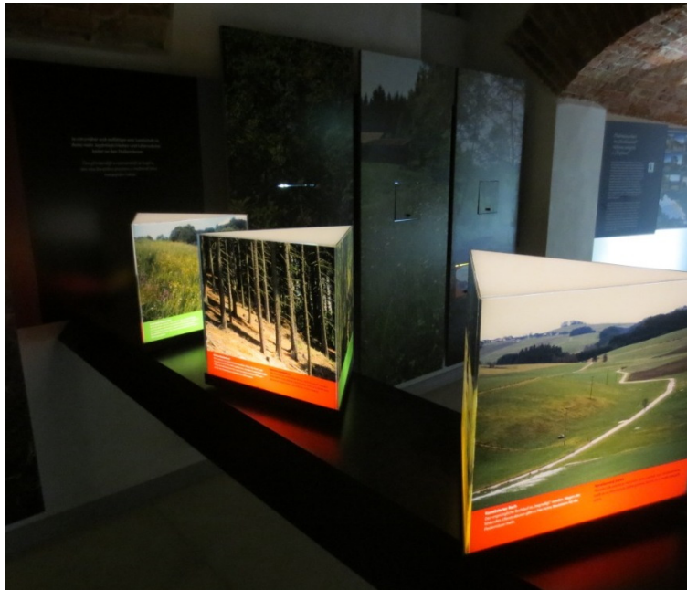
Abbildung 7: Mangelnder Abstand der Drehprismen mit Einklemmgefahr
