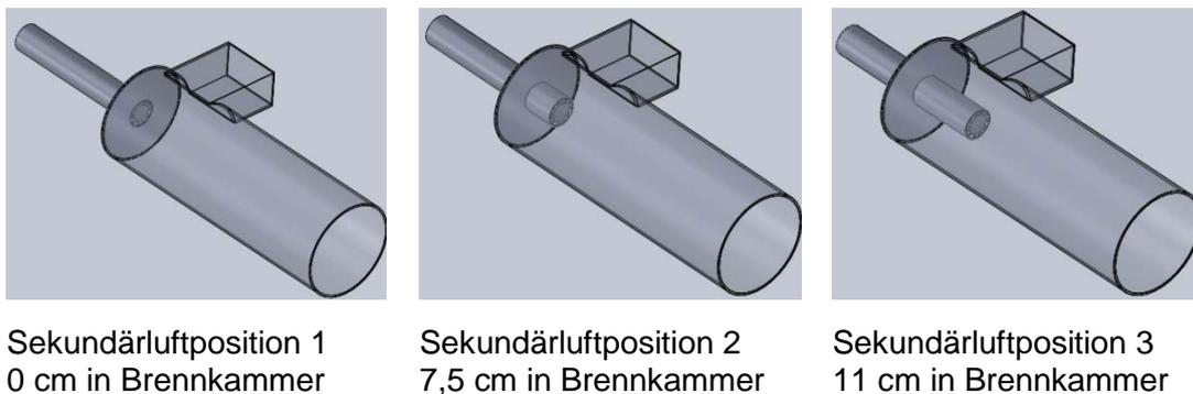
Tabelle 7.4 zeigt die Ergebnisse zum Einfluss der Sekundärluftposition auf die mittleren Gaskonzentrationen während der Hauptverbrennungsphase beim Stückholzmusterkessel. Mit Sekundärluftposition 2 wurden die besten Verbrennungswerte erreicht, die mittlere CO-Konzentration beträgt hier nur noch 15 mg/m<sup>3</sup>.
