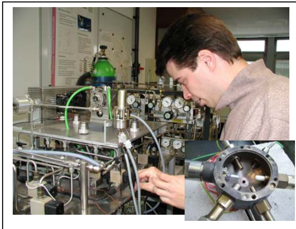
Abbildung 10.1: Gassensor-Testanlage mit heizbarer Sensor-Testzelle (kleines Bild)
