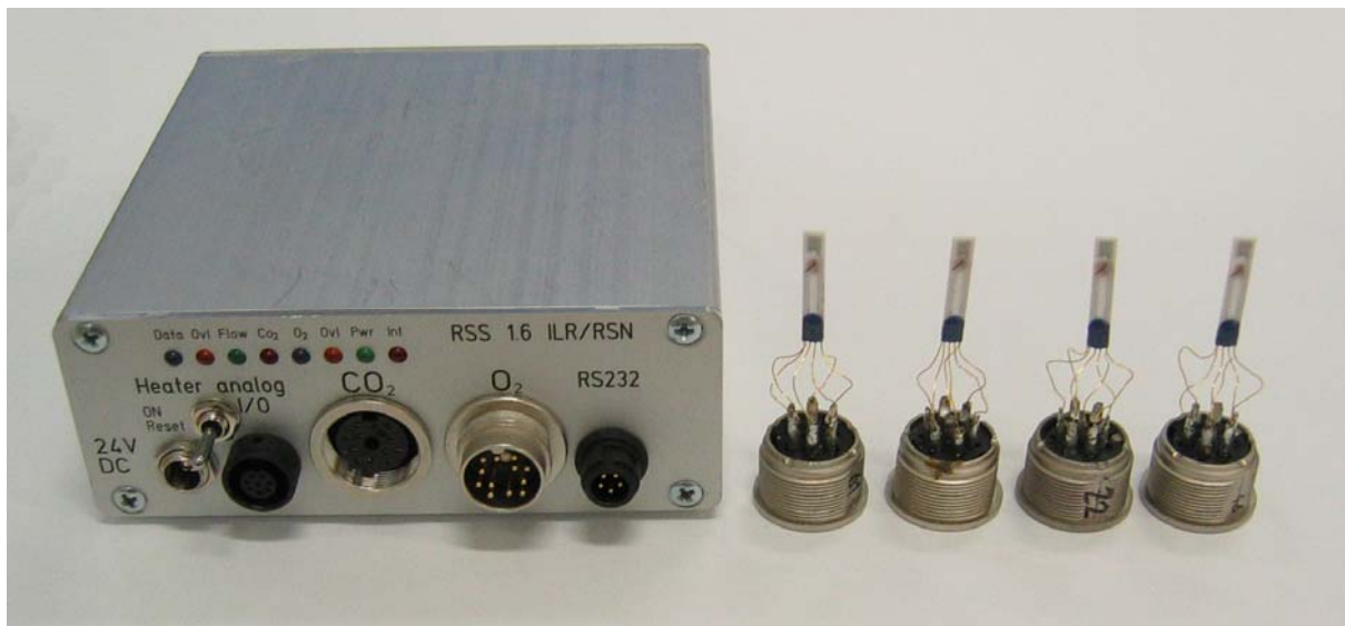
Abbildung 17.3: 4 Stück KombiSen Sensorelemente (3. Charge) angelötet an 6-polige DIN-Stecker (rechts; RSS-Sensorelektronik (Version 1.6 ILR/RSN) mit \text{CO}_2 - und \text{O}_2 -Sensoranschlußbuchsen, Analog I/O-Schnittstelle, RSS232-Schnittstelle, Heizer- und Resetschalter sowie 24VDC-Anschluss (links)
