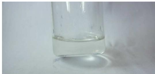
Abbildung 10 Einphasiges System nach einer Minute bei Raumtemperatur durch Alkylkettenverlängerung. Reaktionsgemisch Butanol : Ethylacetat : [BIMBS][HSO<sub>4</sub>] 10 : 10 : 1
