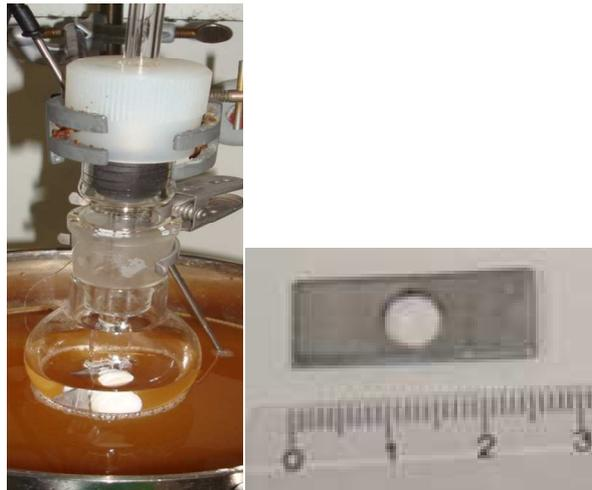
Abbildung 11 Korrosionszustand nach VDMA 24570 (links) Metallplatte aus Edelstahl 1.4571 (rechts)
