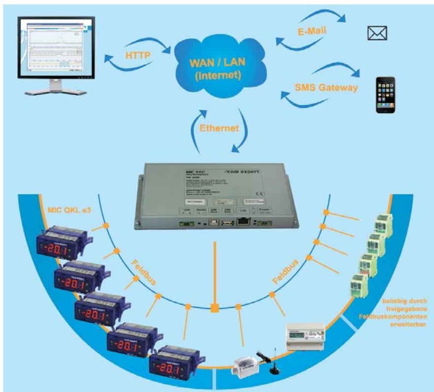
**Abb. 14:** Datenlogger MIC EEC, Integrationsplattform für Regler, Prozessdaten und Energiezählern für ein webbasiertes Energie-Monitoring [Quelle: Cool Expert Entwicklungs GmbH]
