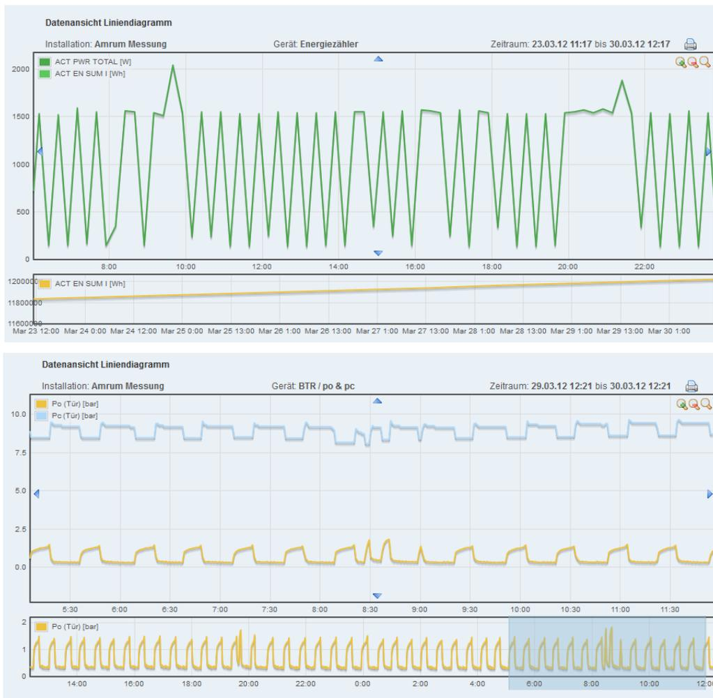
**Abb. 20:** Beispiel für webbasierte Datenaufzeichnung und –visualisierung von Energieverbräuchen und Druckverläufen der Kälteanlage [Quelle: Cool Expert Entwicklungs GmbH]
