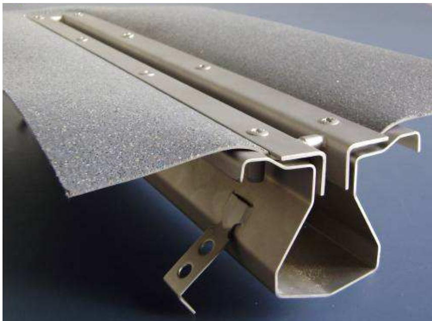
Abbildung 58: Edelstahlmodell der Schlitzrinne mit Sohlgefälle und Klemmflansch zum wasserdichten Anschluss von Bodenbelägen aus Kunststoff (Quelle: Blücher)
