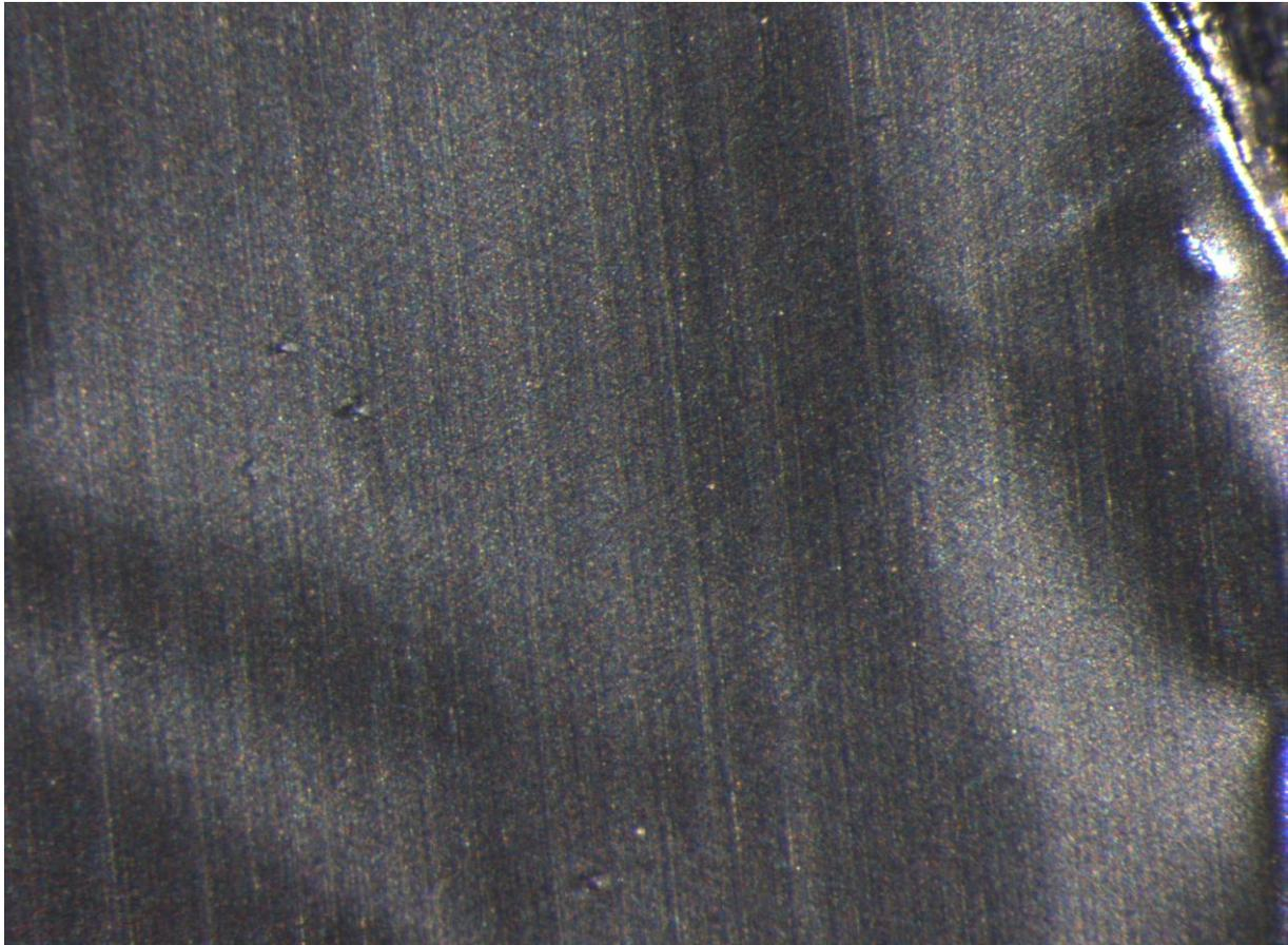
Abb. 180: Lichtmikroskopische Aufnahme der Staubablagerungen auf der Aluminiumfolie
