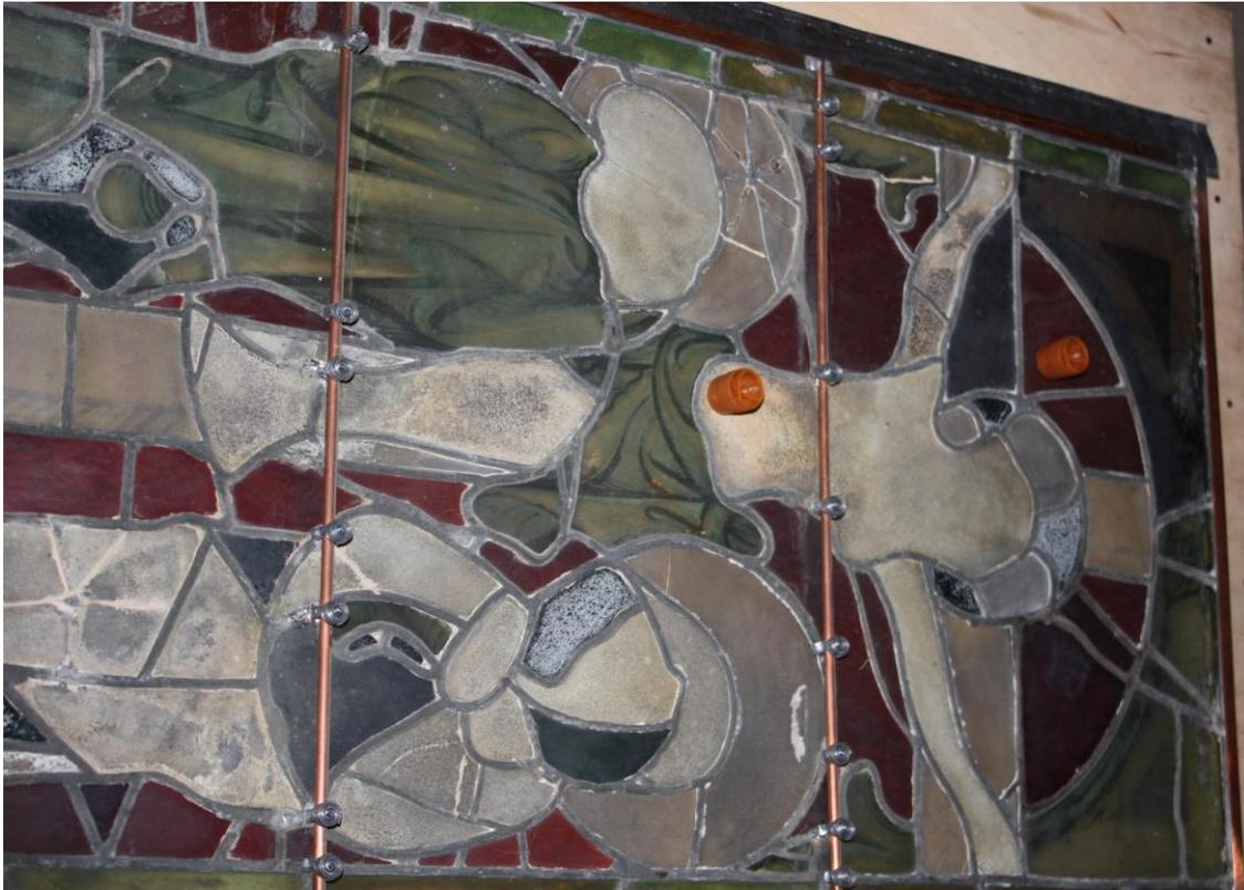
Abb. 320: Staubprobenahme auf der Rückseite des Feldes n IV 3c von der Oberfläche nicht korrodierter und korrodierter Glasoberflächen
