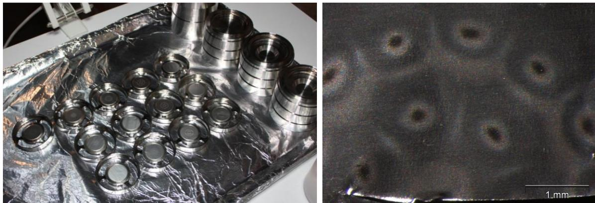
Abb. 178, 179: Stufen des Kaskadenimpaktors nach Staubprobenahme; rechts Detail Staubablagerungen auf Stufe 4
