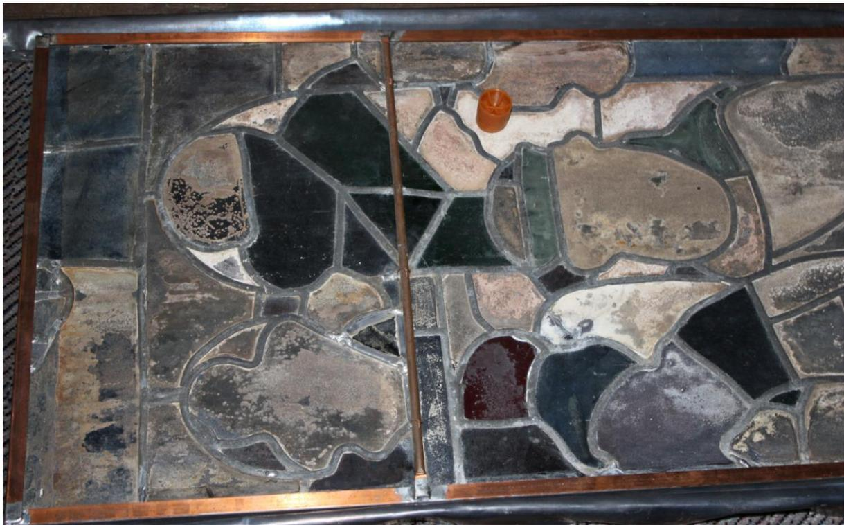
Abb. 291: Staubprobenahme auf der Rückseite des Feldes nXI 3a von der Oberfläche nicht korrodierter und korrodierter Glasoberflächen
