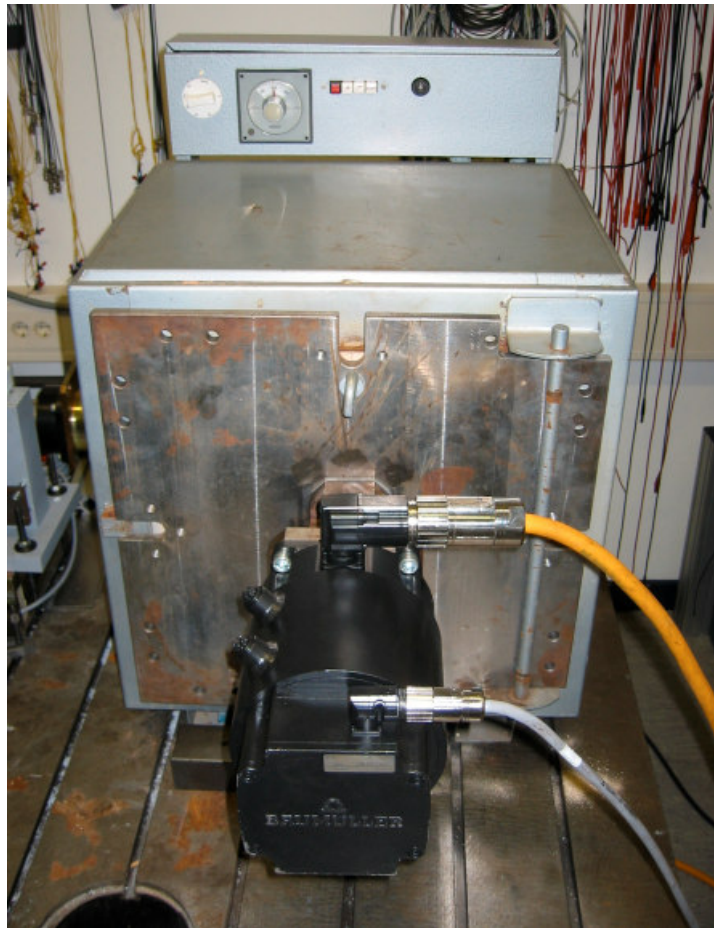
Abbildung 30: Ofen mit eingebauter Klappenaktuatorik
