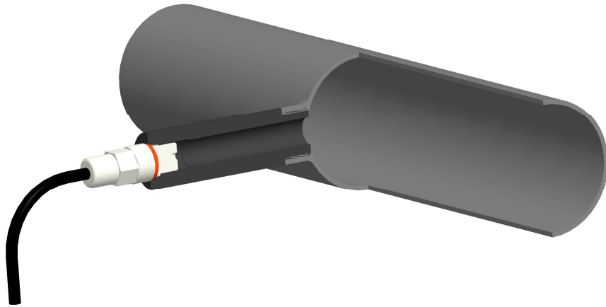
Abbildung 43: Prinzipielle Anbindung des Druckpulsationsaufnehmers über ein Distanzrohr
