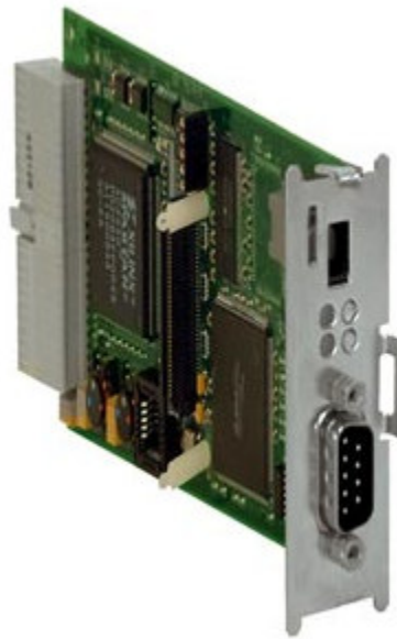
Abbildung 39: Speicherprogrammierbare Steuerung als Einschubkarte für einen modularen Servoregler
