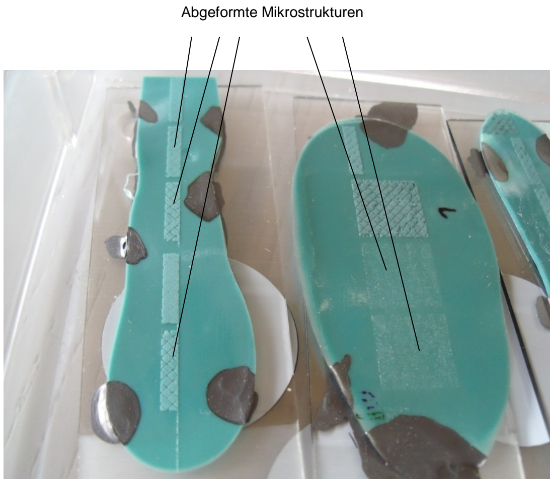
Abb. 9: Replika-Abdrücke von Laser-Mikrostrukturen in ORMOCER® werden zur Qualitätsanalyse verwendet
