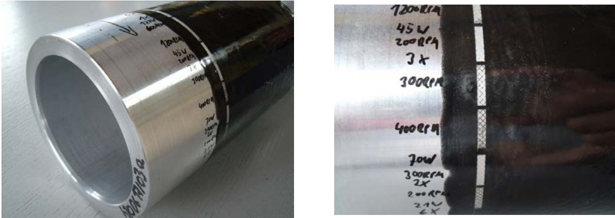
Abb. 8: ORMOCER®-Beschichtung mit erhöhtem Graphitanteil (Typ h100617/03) auf Zylinderrohling (rechts: vergrößerter Detailausschnitt zeigt erste Strukturierungsergebnisse)
