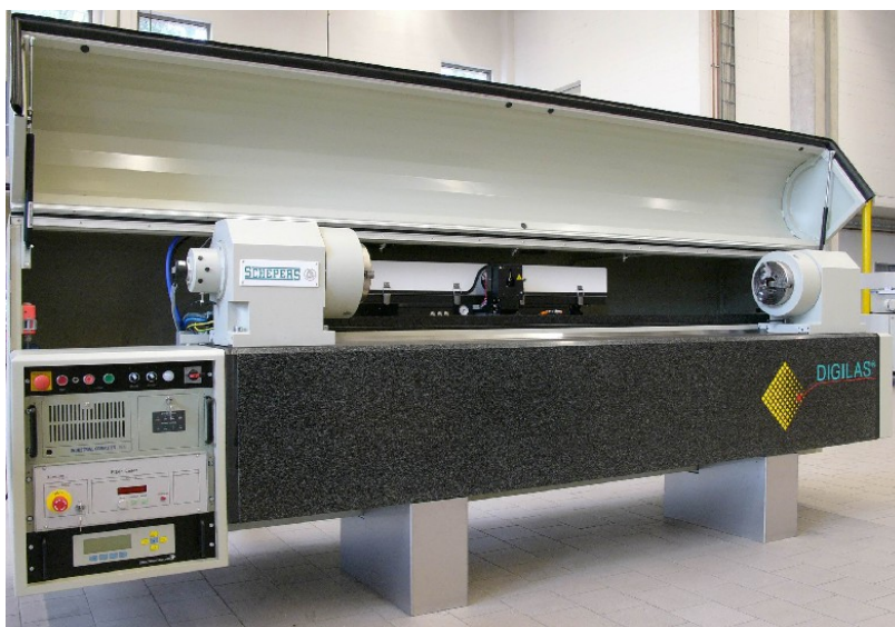
Abb. 1: DIGILAS-Laseranlage zur Mikrogravur von Druckwalzen mit geöffneter Maschinenabdeckung. Die Anlage ist auf einem stabilen, vibrationsfreien Granitbett angeordnet. [Quelle: Schepers GmbH & Co. KG].
