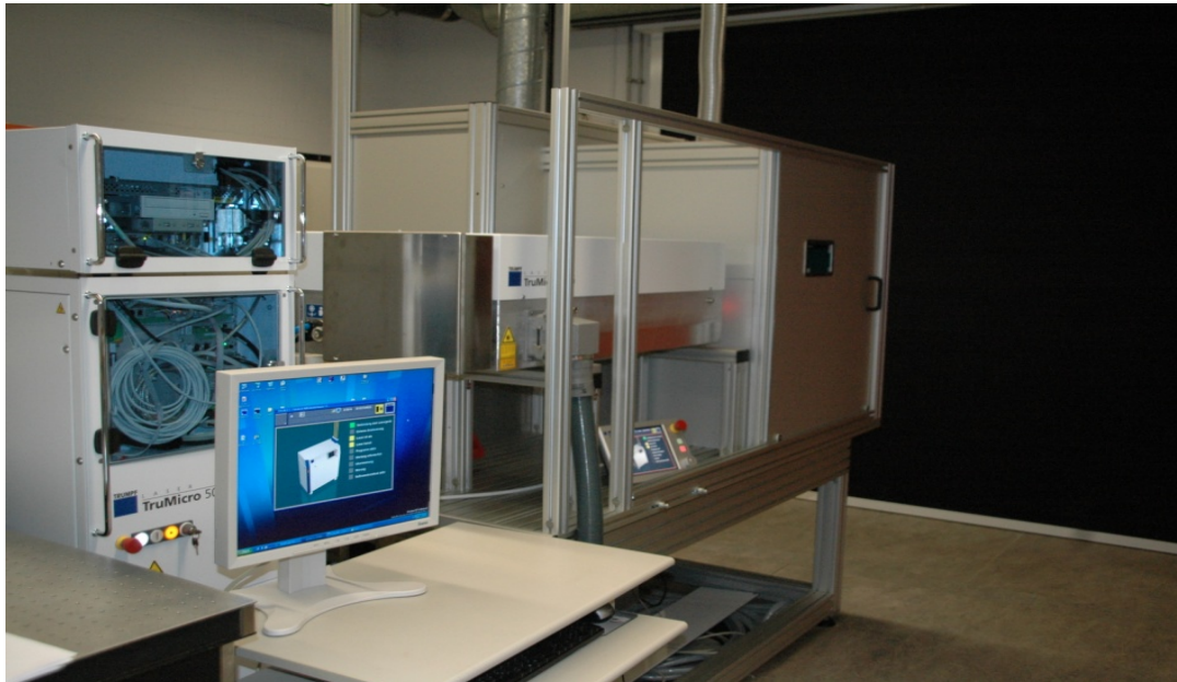
Abb. 6: Pikosekunden-Laser Typ „TruMicro 5050“ mit Bearbeitungskammer beim Projektpartner Laserzentrum (LFM)
