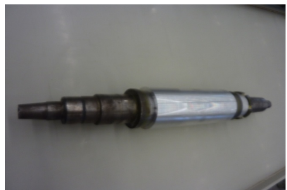
Abb. 7: Mit ORMOCER ® beschichtete Zylinderrohlinge Links: beschichteter Zylinderrohling; rechts: beschichteter Zylinderrohling mit Aufspindelung
