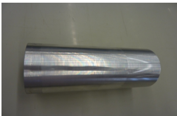
Abb. 7: Mit ORMOCER ® beschichtete Zylinderrohlinge Links: beschichteter Zylinderrohling; rechts: beschichteter Zylinderrohling mit Aufspindelung
