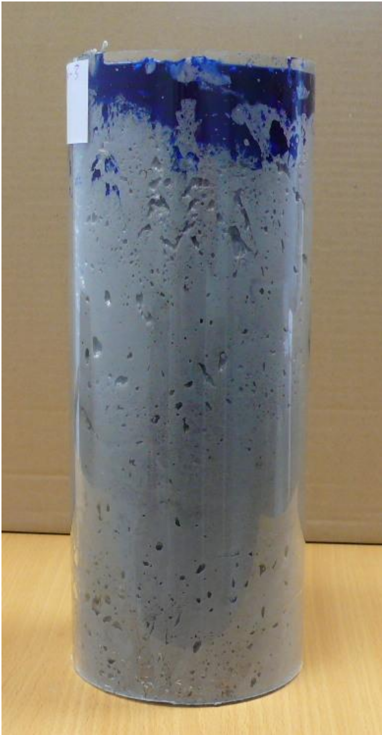
Bild 13: Grauer Schaum im Plexiglasrohr. Oben befindet sich blaues Wasser.
