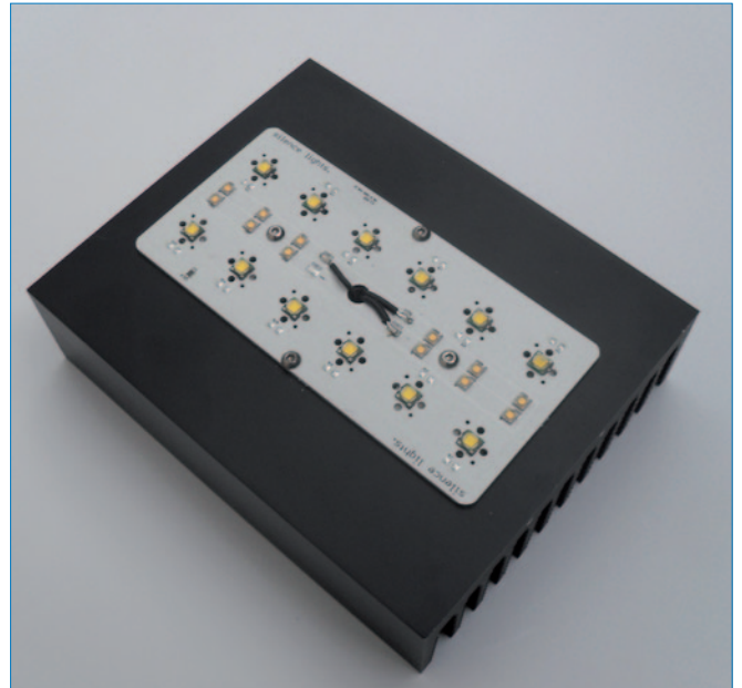
Abb. 27: Prototyp der LED-Leiterplatte für lichttechnische Vermessung
