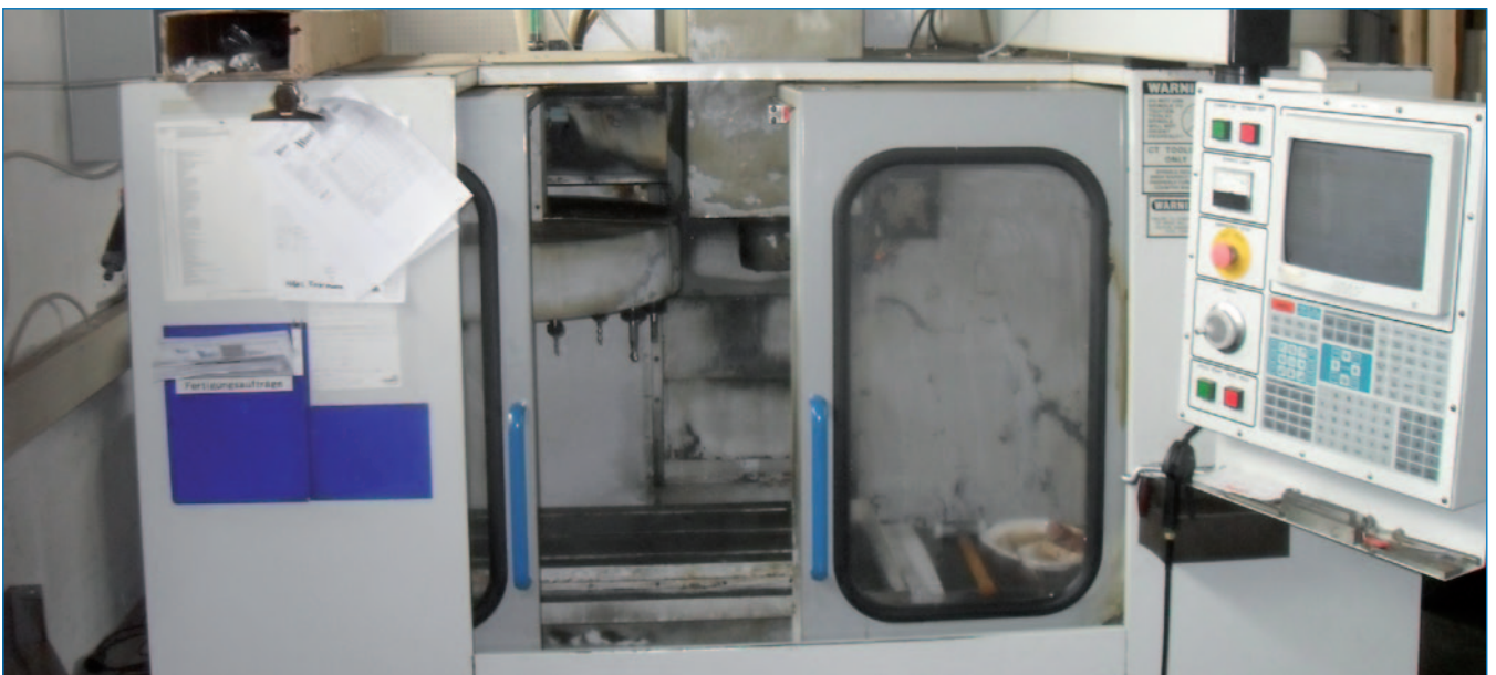
Abb. 50: CNC Fräsmaschine Mikron VCE 750
