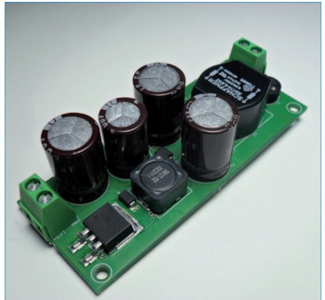
Abb. 29: Prototyp des LED-Vorschaltgeräts »EMT-0911-0000« (Oberseite)
