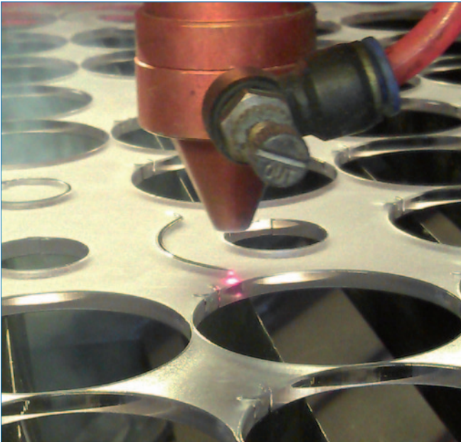
Abb. 54: Plexiglasbearbeitung mittels CO 2 -Laser
