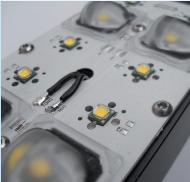
Abb. 26: Prototyp der LED-Leiterplatte für lichttechnische Vermessung
