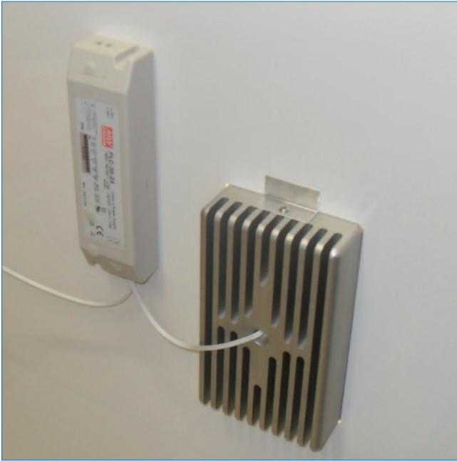
Abb. 02: LED-Modul und Netzteil im Baugruppenträger (Rückseite)
