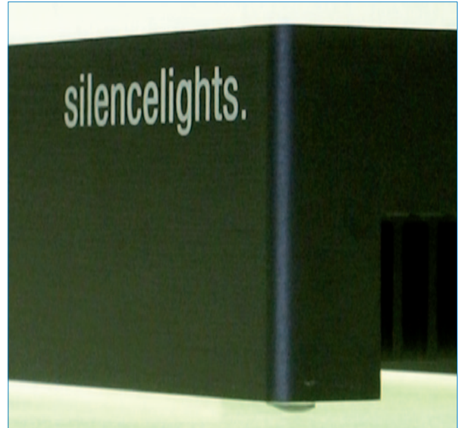
Abb. 55: Lasergravierter Schriftzug in schwarz eloxiertem Aluminium
