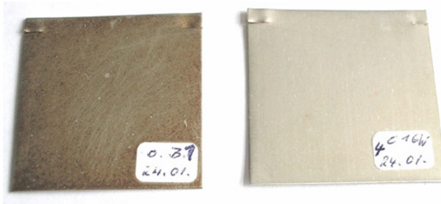
Abbildung 19: Belastungsversuche vergoldeter und beschichteter Proben durch fünfmonatige Lagerung in H_2S Atmosphäre (links: ohne Beschichtung, rechts: Ag Probe beschichtet mit C16/P18-Emulgator)
