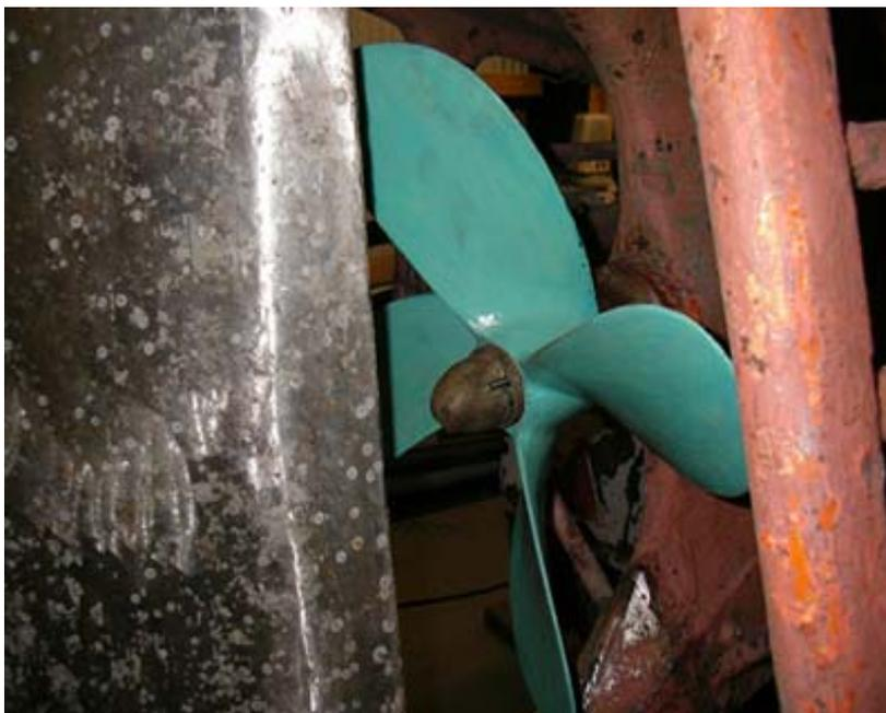
Abb. 11: Per Handapplikation beschichtete Schiffsschraube
