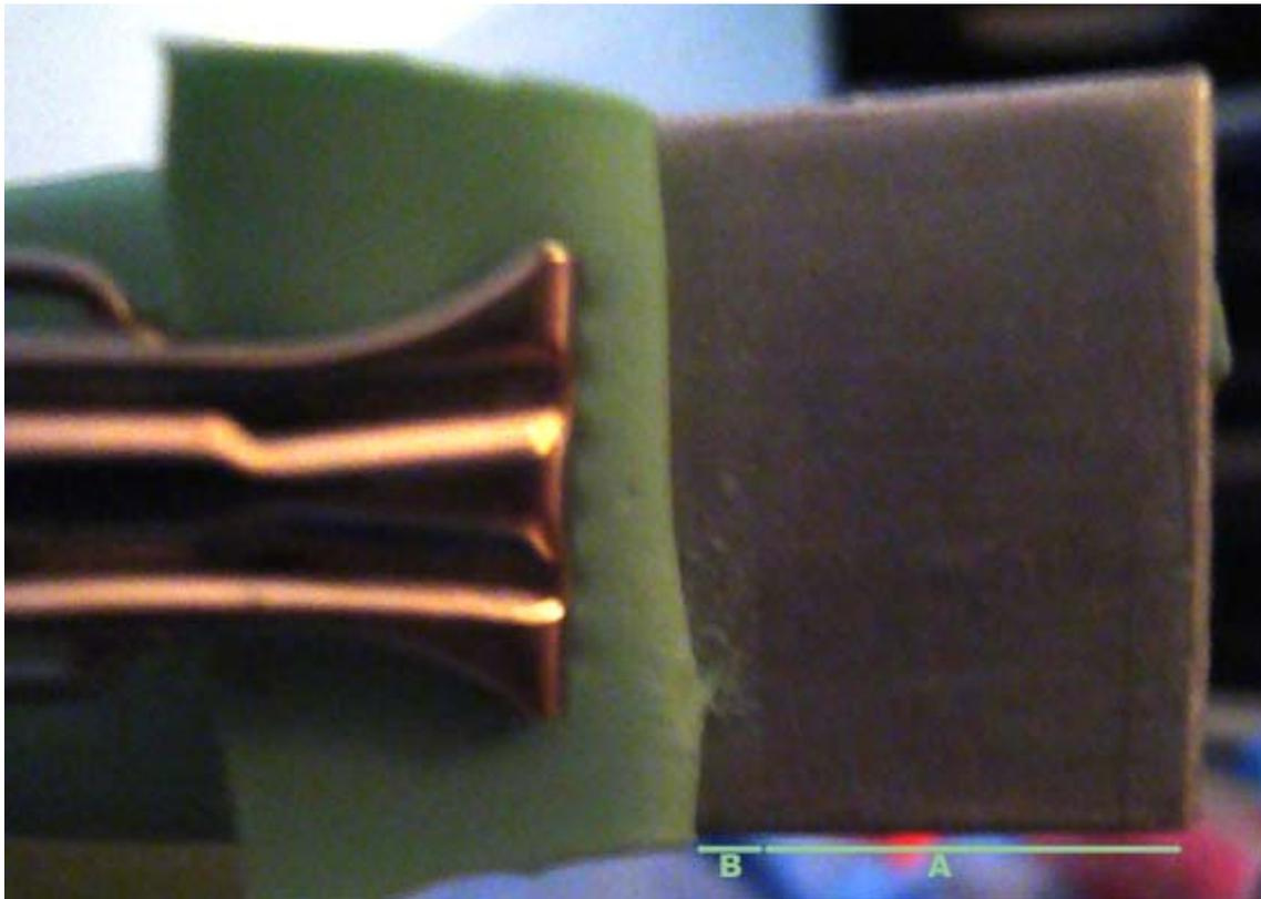
Abb. 5: Abzugsversuch mit Adhäsionsbruch (A) und Kohäsionsbruch (B)
