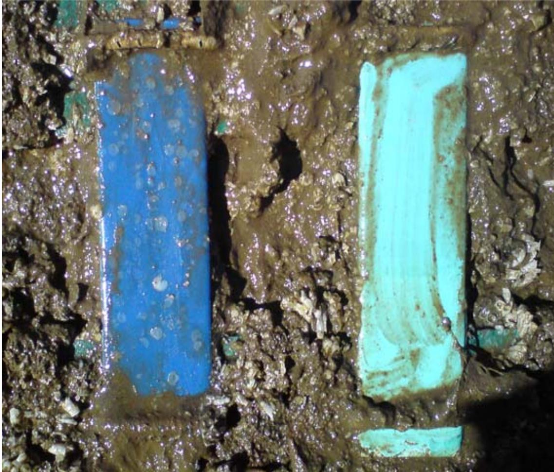
Abb. 13: Das Vergleichsprodukt (blau) und die eigene Beschichtung nach der leichten Schwammreinigung im Juni:
