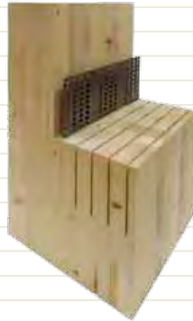
In Brettschichtholz eingeklebtes Lochblech mit dreilöchriger Einbindetiefe
