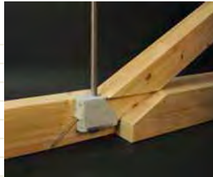
Freigelegter, neuartiger Betonknotenanschluss für Holzfachwerke
