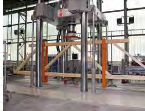
Ausführungsbeispiel: Fachwerkträger-Ausschnitt bei der Traglastprüfung
