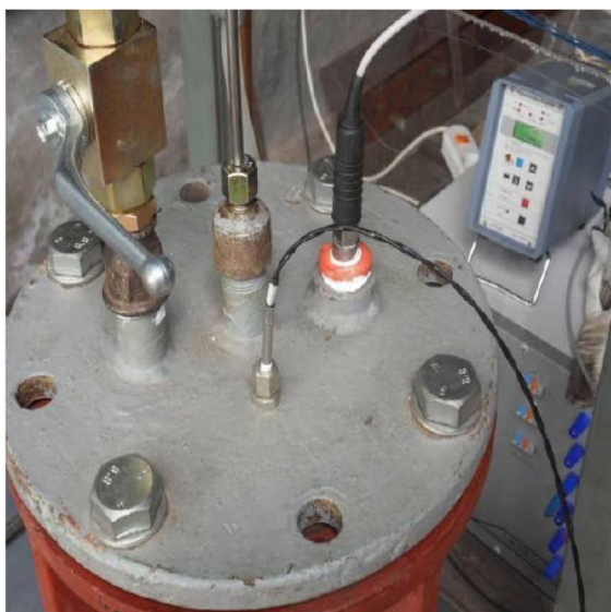
Abbildung 20: Versuchsaufbau Nageltest im Druckgefäß
