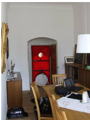
Bild 25: Blower Door Messung im Gästerefektorium Raum 99. Das linke Bild zeigt die Anordnung der Blower Door für die Unterdruckmessung mit verschlossener Ventilatorblende für Messung des natürlichen Druckunterschiedes. Im Rechten Bild ist im gleichen Raum das neue Fenster zu sehen. Im Fenster, nicht sichtbar oben angeordnet, befindet sich eine selbstbetätigende Lüftungsklappe.
