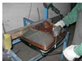
6. Entfernen des Spannbandes und Fixieren der Bildröhre auf dem Schlitten der Bildröhrentrennung
