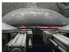
7. Erhitzen der Bildröhre mit Hilfe eines Heizdrahtes; die erhitzten Stellen werden mit einem nassen Schwamm befeuchtet; evtl. Abklopfen der Bildröhre bis sich das Konusglas vom Schirmglas trennt
