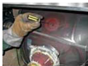
2. Belüftung der Bildröhre
