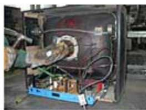
3. Entfernen der Ablenkeinheit
