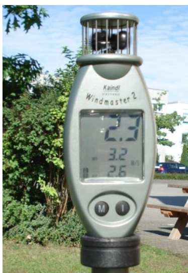
Abbildung 7: Richtungsunabhängiger Windmesser zur Bestimmung der Windgeschwindigkeit
