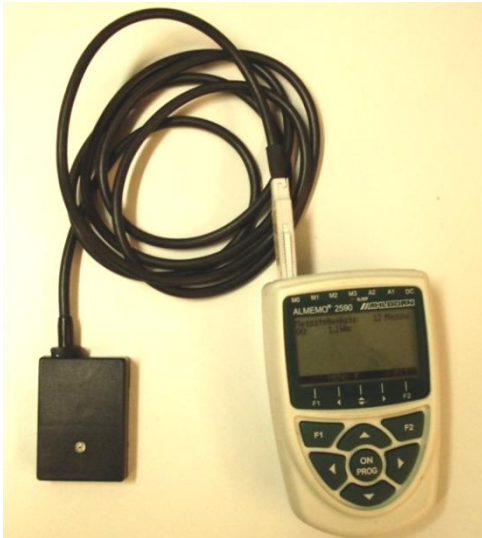
Abbildung 8: Einstrahlungssensor mit ALMEMO Messgerät
