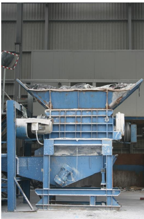
Abbildungen 14 und 15: Aggregate (Shredder) zur Abtrennung von Störstoffen.
