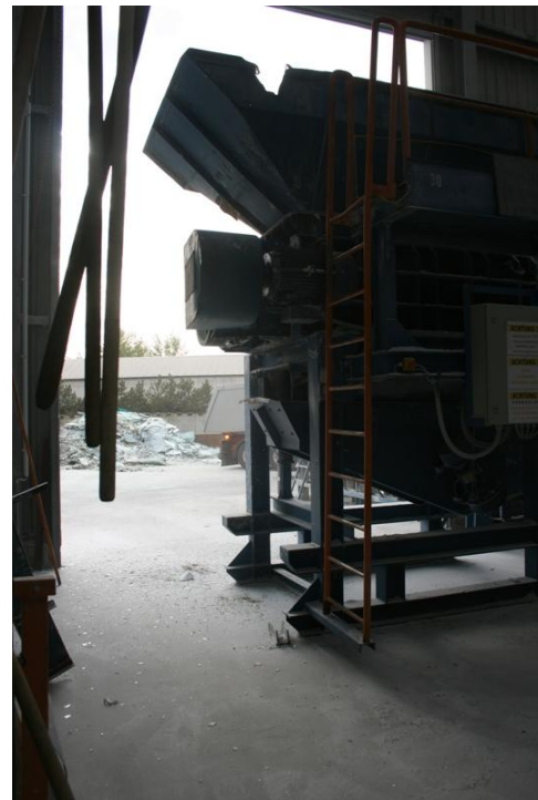
Abbildungen 14 und 15: Aggregate (Shredder) zur Abtrennung von Störstoffen.
