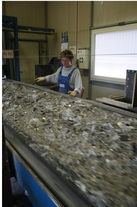
Abbildung 16: Händische Sortierung zur Abtrennung von Störstoffen. Die höchste Staubbelastung ist beim Shredderprozess erkennbar, bei dem keine ständigen Arbeitsplätze vorhanden sind.
