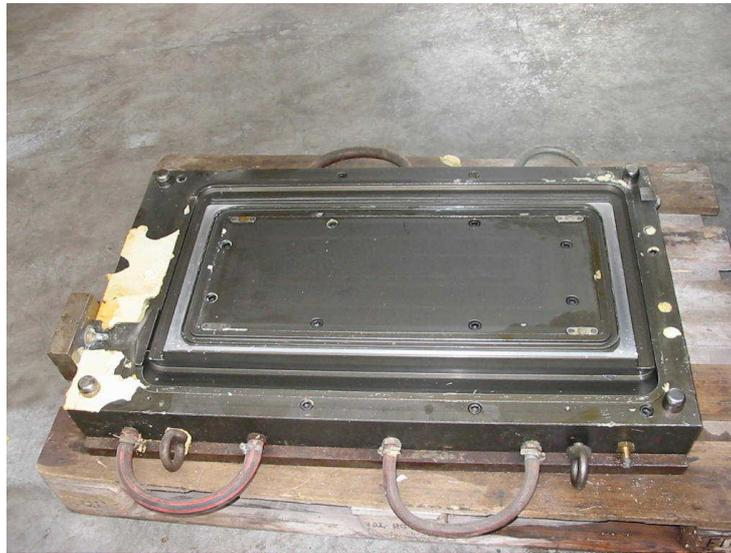
Bild 4: Ein stark mit Trennmittel- und Kunststoffresten verunreinigtes Formwerkzeug vor der Reinigung
