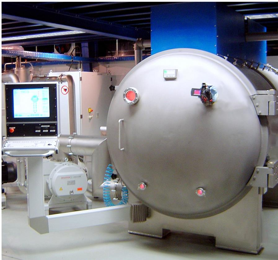
Bild 8: Ein Niederdruck-Plasmareaktor
