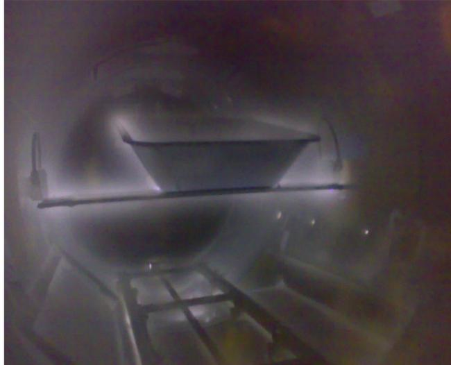
Bild 15: Großflächiges Dummy-Entformungswerkzeug während der Beschichtung. Durch die Schaltung des Werkzeugs als HF-Elektrode entsteht sichtbar das Plasma auf der Werkzeugoberfläche
