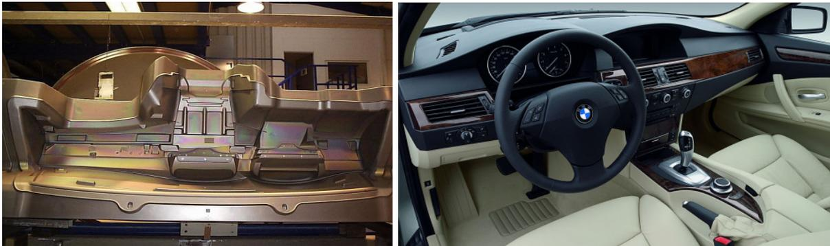
Bild 9 und 10: Ein beschichtetes Produktionsentformungswerkzeug der IMC-PUR-Sprühhauffertigung im BMW Werk Landshut (links) sowie eine fertig montierte Instrumententafel aus Kunststoff (rechts)
