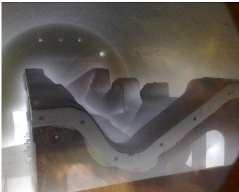
Bild 24: Instrumententafelformwerkzeug des BMW Werkes Landshut im Plasmareaktor während des Beschichtungsprozesses
