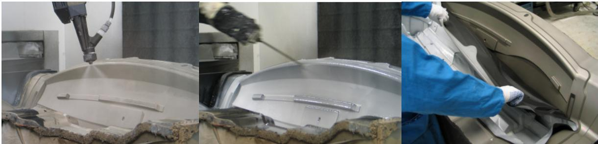
Bilder 1-3: Trennmittelapplikation (links) auf einer Werkzeugformoberfläche per Roboter, Kunststoffeintragung ins Formwerkzeug (mittig) und Entformung des Bauteils nach der Aushärtung des Kunststoffes (rechts)
