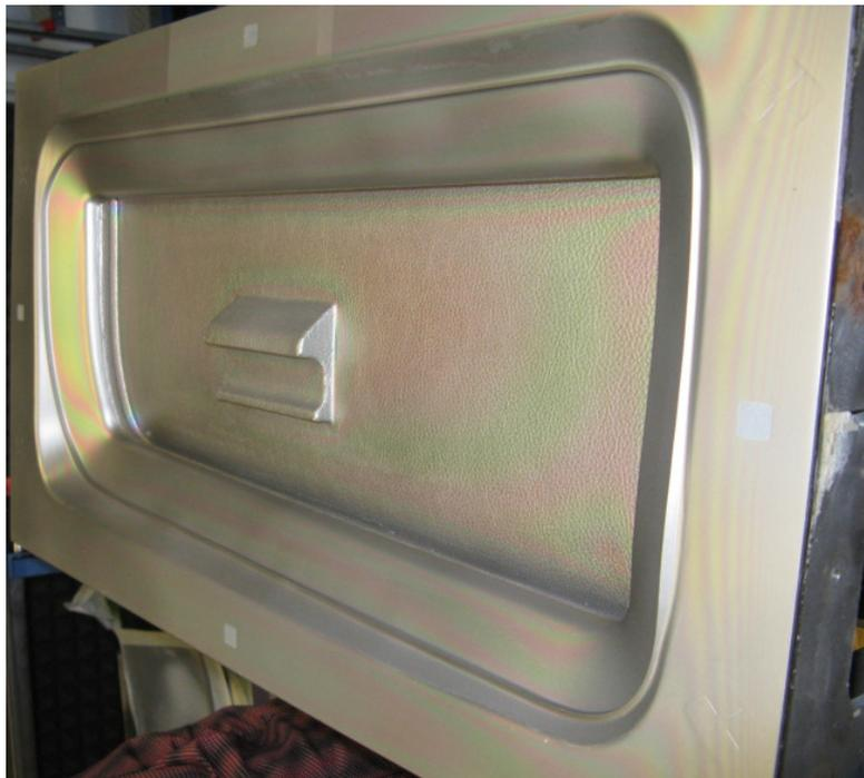
Bild 20: Handschuhkastendeckel, Formwerkzeug des BMW Werkes Landshut, beschichtet mit der plasmapolymere Trennschicht unter Hochratebedingungen
