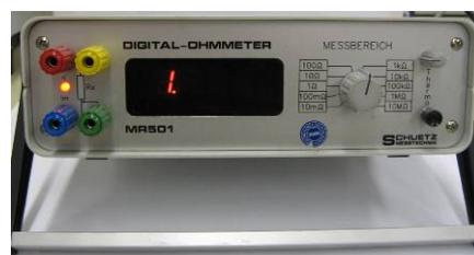
Abb. 14: 4-Kanal-Widerstand-Messgerät
