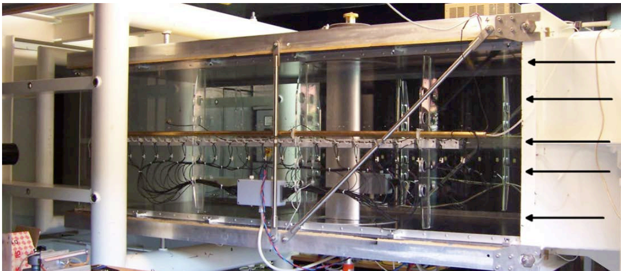
Abbildung 32: Geschlossene Messstrecke mit Wanddrucksensoren und montiertem Rotorblattprofil, aus [Sch09].
