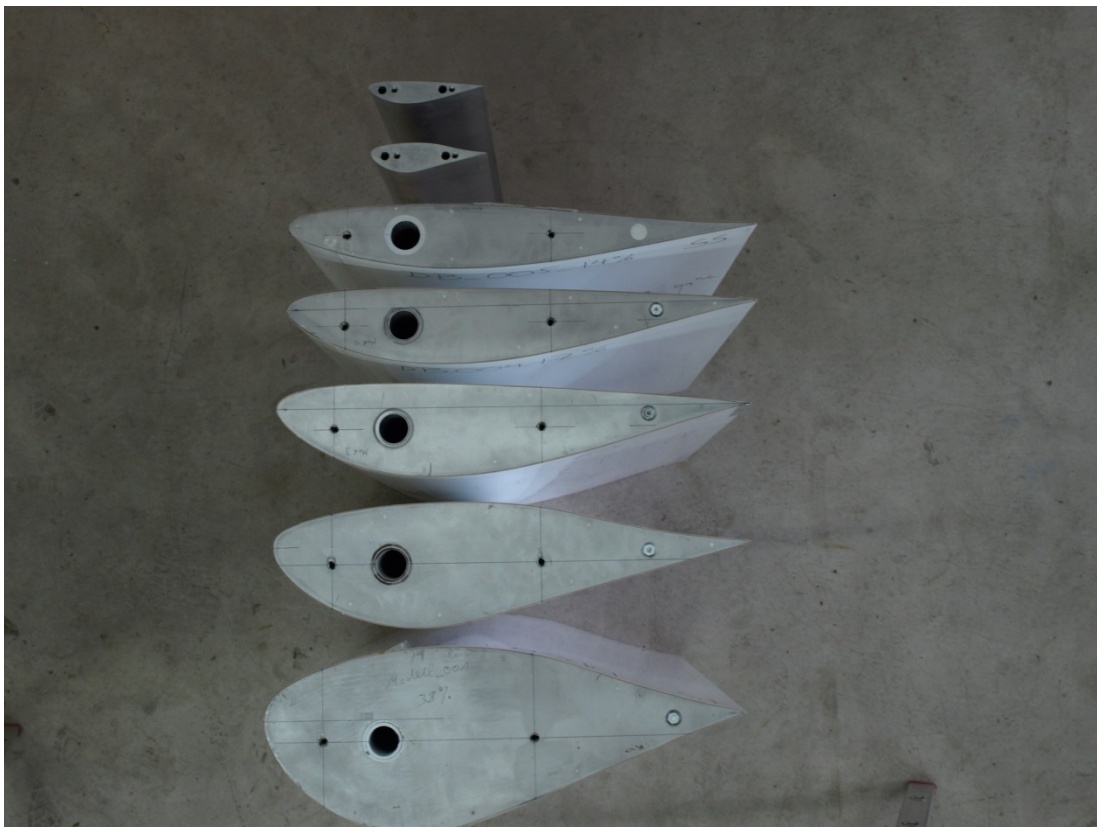
Abbildung 18: Fertige Modelle der fünf Profilabschnitte
