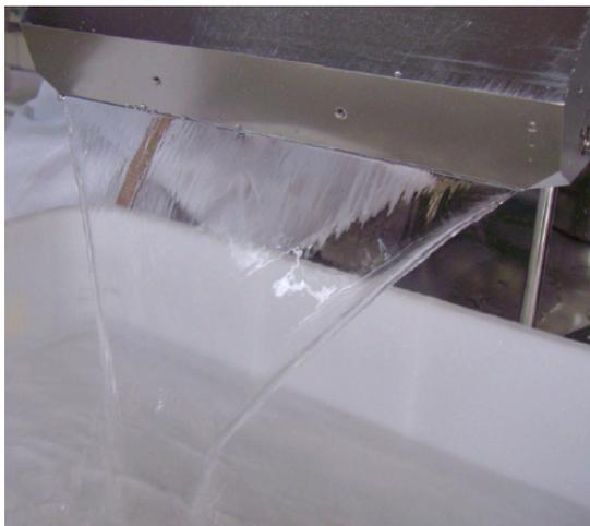
**Abbildung 8:** Bild des Wasservorhanges der Schlitzdüse (Distanzfolie 0,1 mm, 0,6 MPa Gasdruck, 3.000 mL/min Volumenstrom)
