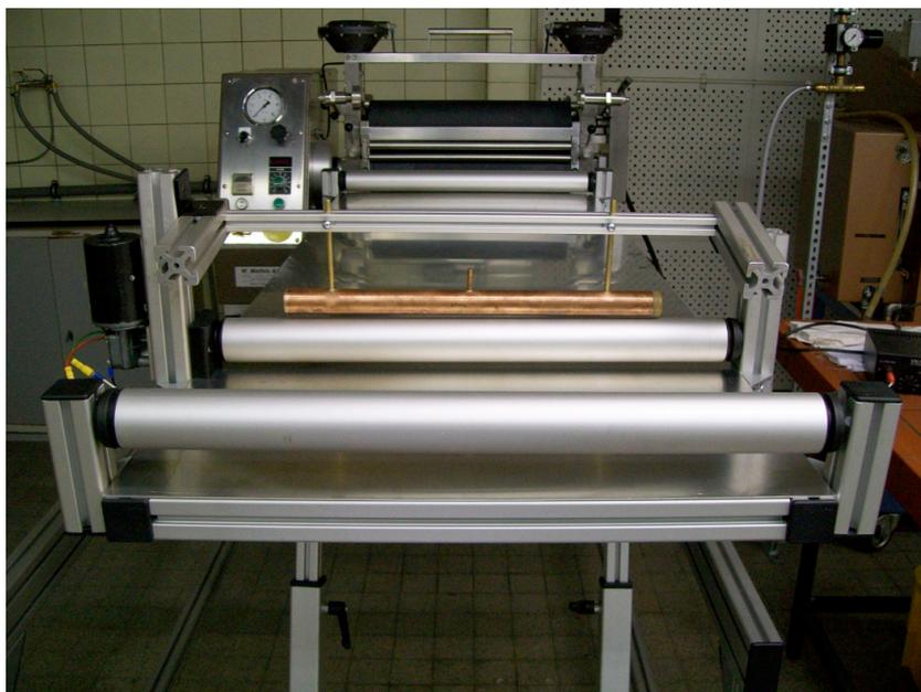
**Abbildung 4:** Bild der Versuchsanlage zum Flottenauftrag mittels Spritzrohr (Kupferrohr) und Walze (Aluminium), die zur Übertragung der Flotte auf die Warenbahn diente. Im Hintergrund ist der Foulard zu erkennen, der ohne Anpressdruck der Walzen zum Transport der Warenbahn benötigt wurde.
