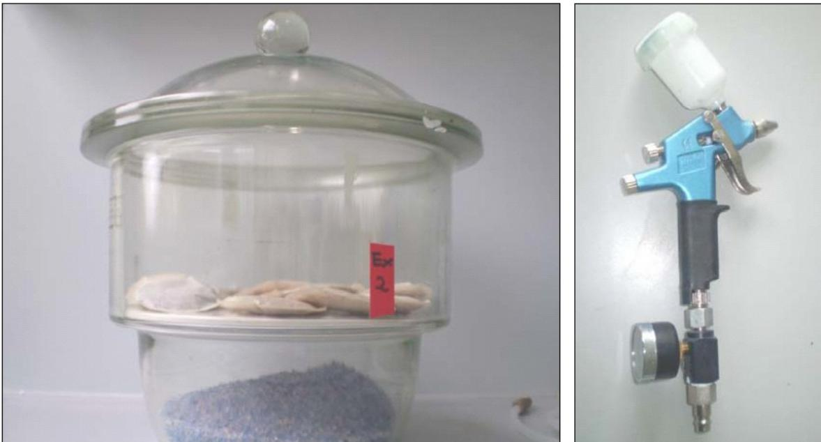
Abbildung 9a/9b: Konditionierung der Filterpads im Exsikkator und SATA Lackierpistole
