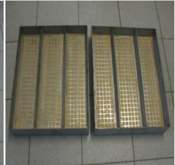
b) Filterkasten bestückt mit Sägemehl (3cm/lockere Schüttung)
