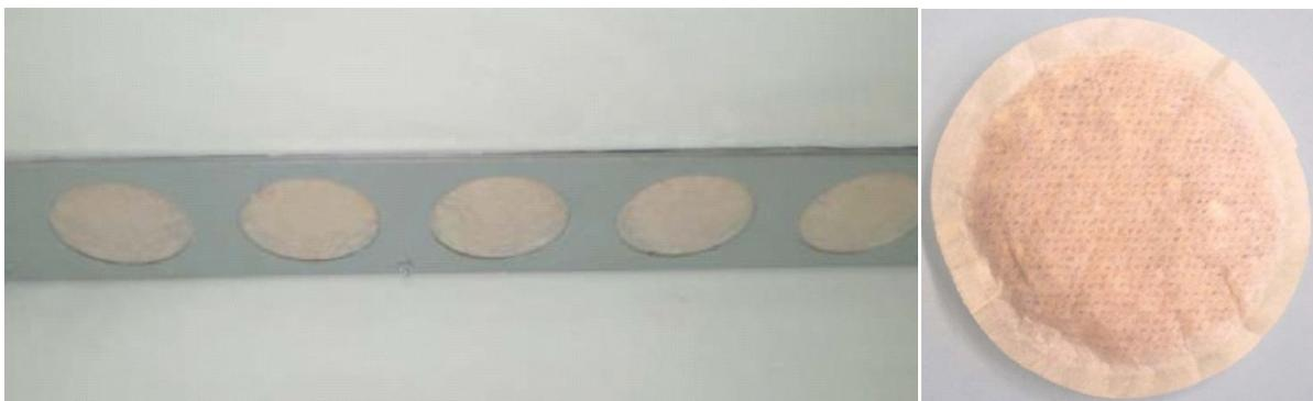
Abbildung 8a/ b: Eingebautes Filterelement und Filterpad
