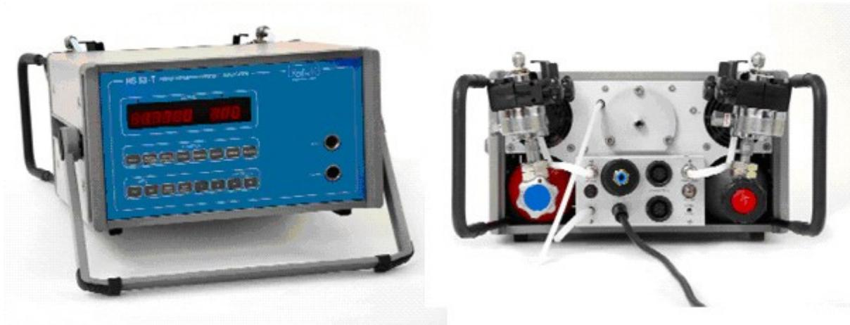
Abbildung 11: Flammen-Ionisations-Detektor
