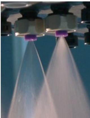
Abbildung 3-11: Sprühstrahl mit Stabilisator
