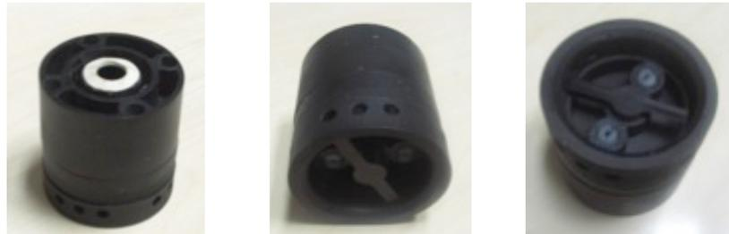
Abbildung 3-4: Prototyp PP gespritzt
