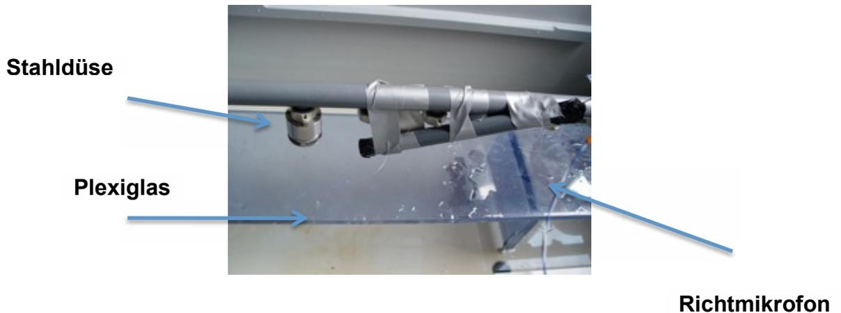
Abbildung 3-6: Frequenzmessung
