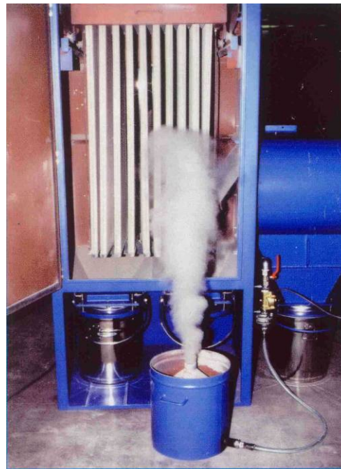
Abbildung 22: Injektion des Additives zum Schutz der Filterelemente
