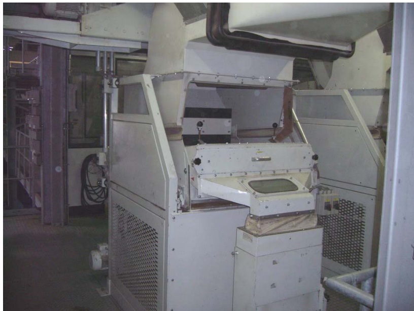
Abbildung 3: Aufbereitung MBS - Trenntisch
