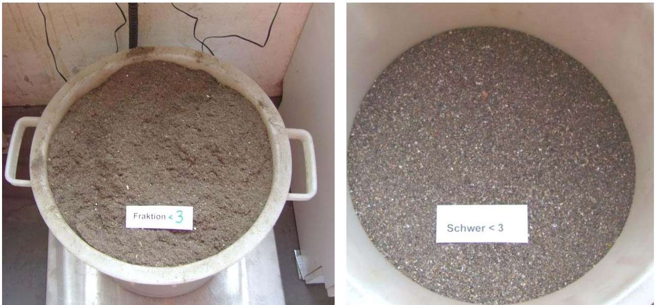
Abbildung 19: Aufbereitete Feinfraktion < 3 mm – links leicht – rechts schwer
