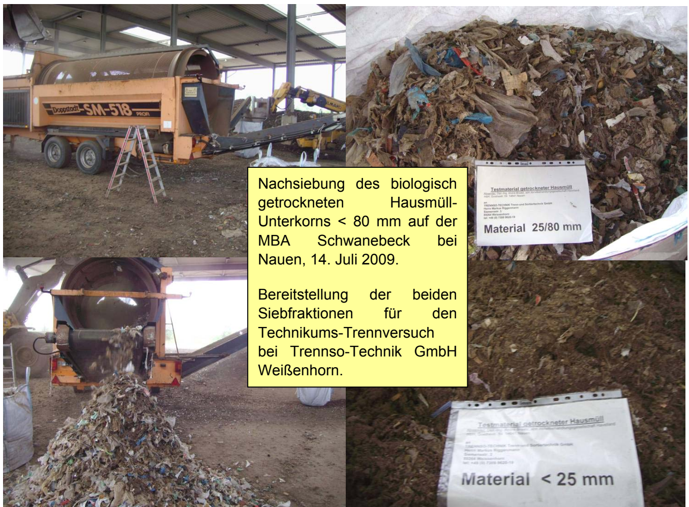
Abbildung 12: Nachsiebung des getrockneten Hausmüll-Unterkorns auf der MBA Schwanebeck
