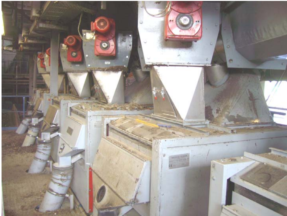
Abbildung 27: Trenntische Leicht- und Schwerfraktion
