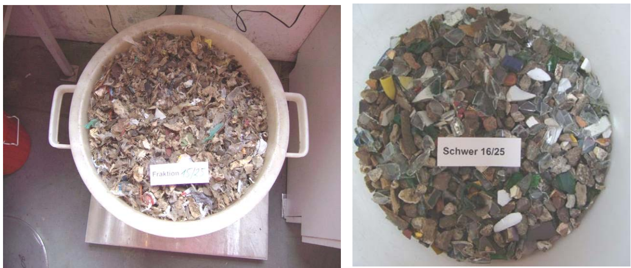
Abbildung 20: Aufbereitete Grobfraktion 15 / 25 mm – links leicht – rechts schwer
