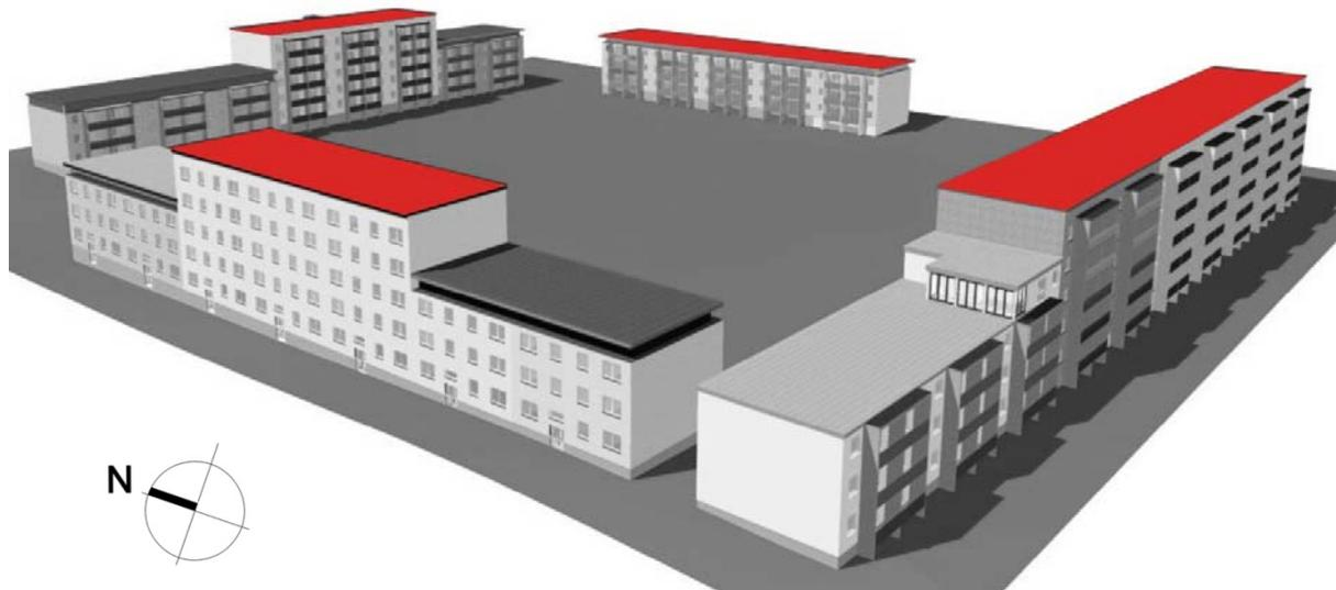
**Abb. 34:** Mögliche Dachflächen zur Nutzung von PV-Modulen und Solarkollektoren (rot gekennzeichnet)
