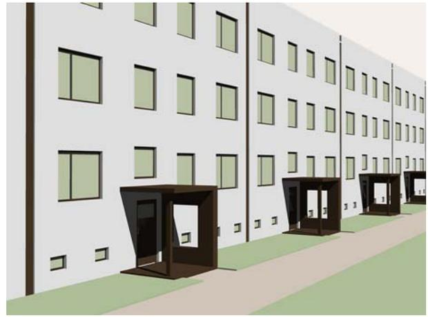
**Abb. 109:** Farblich abgesetzte Loggien (li.), neu gestaltete Eingangsbereiche aus rückgebauten Plattenelementen (re.)
