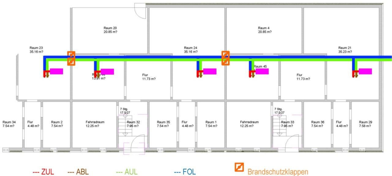
**Abb. 139:** Aufstellung der Lüftungsgeräte im Kellergeschoss und Leitungsverlauf (Konzeption GWJ / WBG)<sup>88</sup>
