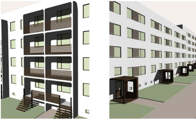
**Abb. 112:** Loggien mit Holzverkleidung (li.), Eingangsbereiche aus rückgebauten Plattenelementen (re.)
