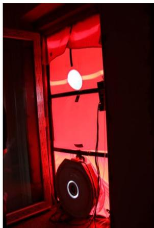
**Abb. 147:** Blower-Door-Test-Messung (09/2011), Hauseingangstür
