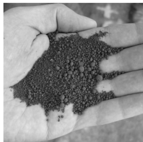
Abbildung 12: Klinkergranalien nach GDO
